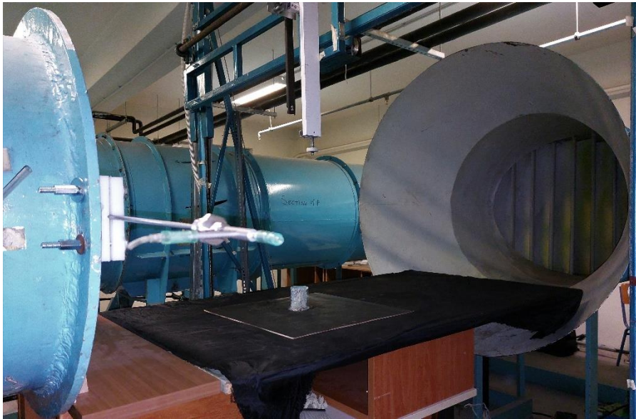
Σχήμα 3-1 Ανοιχτός θάλαμος δοκιμών αεροσήραγγας
