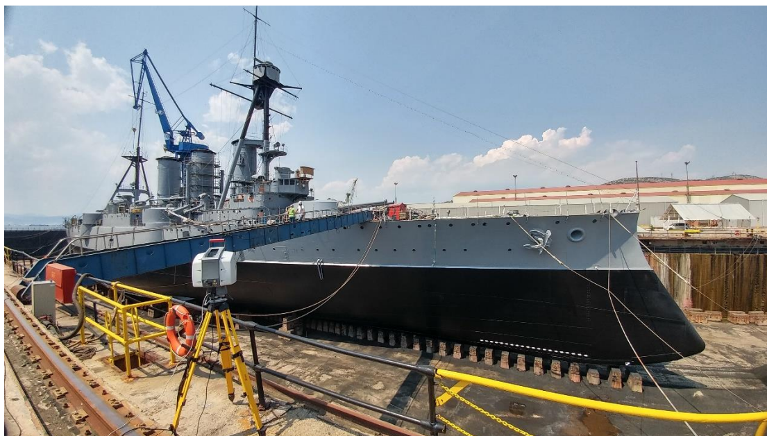
Εικόνα 4.4 Επίγειος σαρωτής ScanStation 2 στο Ναυπηγείο Σκαρμαγκά
