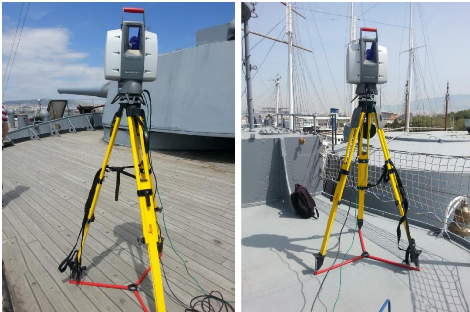
Εικόνα 4.2 Επίγειος σαρωτής ScanStation 2
