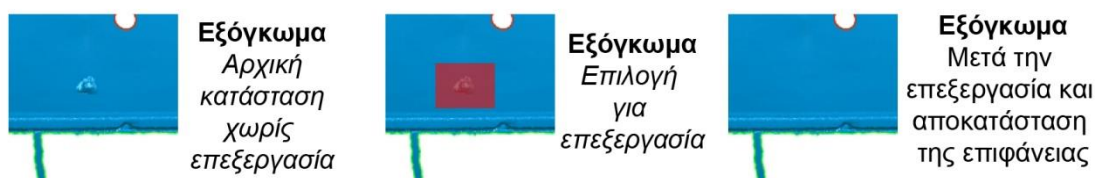
Εικόνα 4.31 Αποκατάσταση ανωμαλίας στην επιφάνεια
