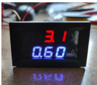
Εικόνα 50: Η ένδειξη του ρεύματος DC κινητήρα όταν αυτός λειτουργεί με το μέγιστο φορτίο και όταν στα άκρα του έχει εφαρμοστεί DC τάση ίση με 3V
