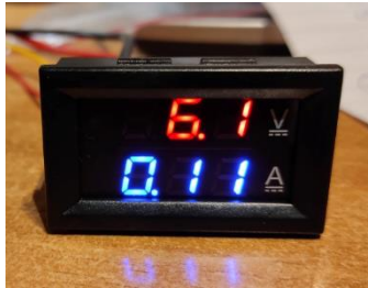
Εικόνα 47: Η ένδειξη του ρεύματος DC κινητήρα όταν αυτός λειτουργεί με το ελάχιστο φορτίο και όταν στα άκρα του έχει εφαρμοστεί DC τάση ίση με 6V
