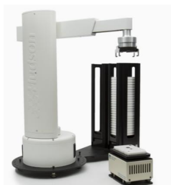
Εικόνα 17: Ρομποτικός χειριστής σταθερής βάσης κυλινδρικής διαμόρφωσης [25]
