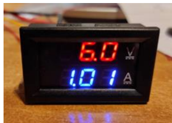
Εικόνα 48: Η ένδειξη του ρεύματος DC κινητήρα όταν αυτός λειτουργεί με το μέγιστο φορτίο και όταν στα άκρα του έχει εφαρμοστεί DC τάση ίση με 6V
