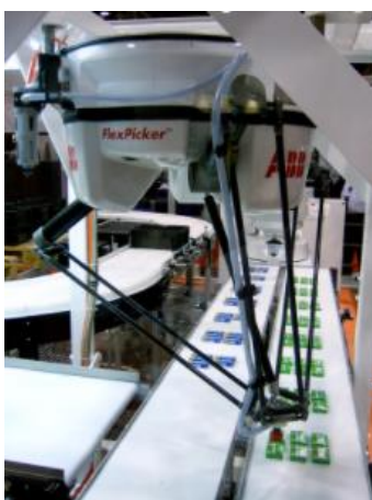
Εικόνα 21: Ρομποτικός χειριστής σταθερής βάσης διαμόρφωσης δέλτα [31]
