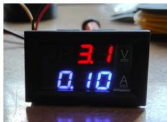
Εικόνα 49: Η ένδειξη του ρεύματος DC κινητήρα όταν αυτός λειτουργεί με το ελάχιστο φορτίο και όταν στα άκρα του έχει εφαρμοστεί DC τάση ίση με 3V
