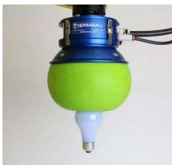
Εικόνα 37: Λαβίδα εύκαμπτης σφαιρικής διαμόρφωσης [55]
