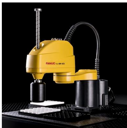
Εικόνα 20: Ρομποτικός χειριστής σταθερής βάσης διαμόρφωσης Scara [29]
