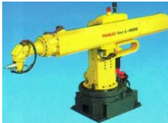
Εικόνα 18: Ρομποτικός χειριστής σταθερής βάσης σφαιρικής ή πολικής διαμόρφωσης [26]
