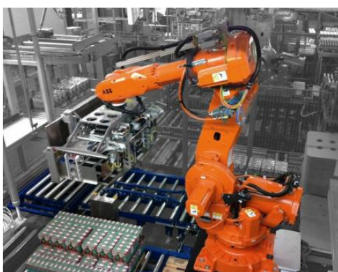
Εικόνα 19: Ρομποτικός χειριστής σταθερής βάσης αρθρωτής διαμόρφωσης [28]
