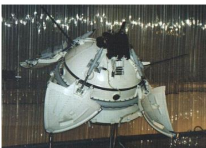
Εικόνα 14: Το προσεδαιφιστικό σκάφος του διαστημικού σκάφους Mars 2 [20]
