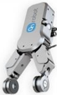
Εικόνα 33: Λαβίδα μηχανικής πίεσης [49]
