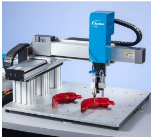
Εικόνα 15: Ρομποτικός χειριστής σταθερής βάσης καρτεσιανής διαμόρφωσης [23]
