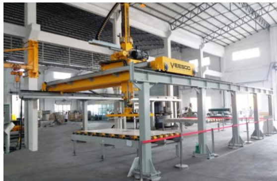
Εικόνα 16: Ρομποτικός χειριστής σταθερής βάσης διαμόρφωσης Gantry [24]
