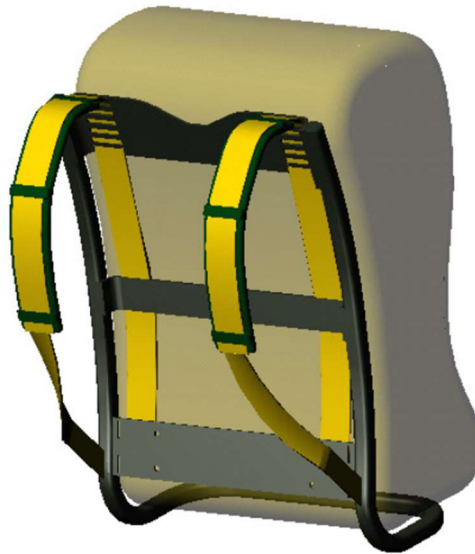
Σχήμα 45. Σχηματική αναπαράσταση ενός backpack με πιεζοηλεκτρικούς ιμάντες [170].
