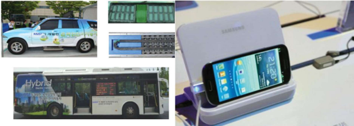
Σχήμα 71. Ηλεκτρικά οχήματα (αριστερά) και φορτιστής κινητού (δεξιά) που λειτουργούν με επαγωγική ασύρματη μεταφορά ενέργειας.
