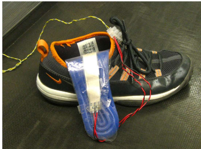
Σχήμα 44. Πρωτότυπη συσκευή με πιεζοηλεκτρικό φιλμ που τοποθετείται σε παπούτσι [169].
