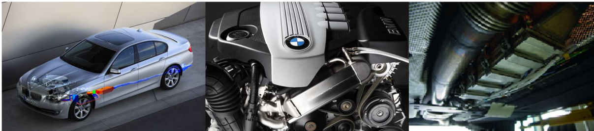
Σχήμα 26. TEG που χρησιμοποιούνται σε αμάξια BMW, για την παραγωγή ηλεκτρικής ενέργειας από την θερμότητα που παράγεται κατά την κίνηση του αυτοκινήτου [93].
