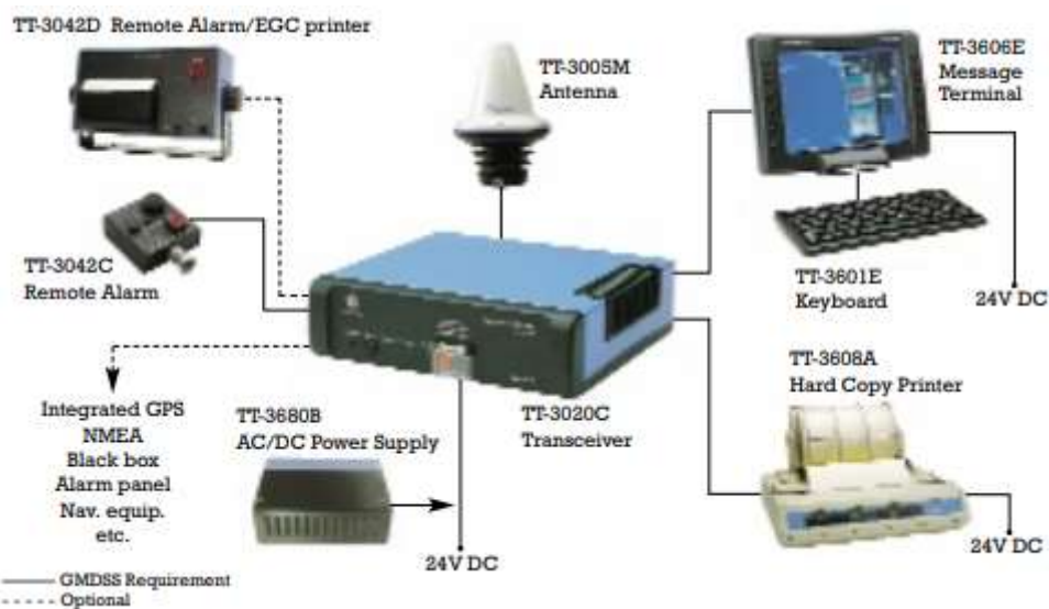
Σχήμα 3.2.6.3 Η σύνδεση όλων των εξαρτημάτων που απαιτούνται για την ορθή και ολοκληρωμένη λειτουργία του TT-3020C Inmarsat-C/GPS Maritime GMDSS Capsat.
