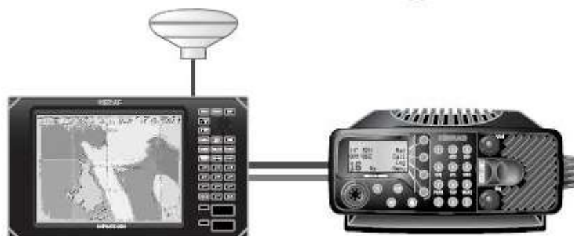
Σχήμα 2.3.1.4.1 Φωτογραφία που δείχνει την σύνδεση του ασύρματος σε συσκευή εντοπισμού θέσης
