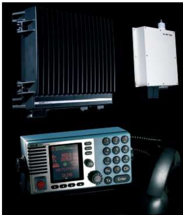
Σχήμα 2.4.1 Βασικά εξαρτήματα ενός ασύρματος MF/HF.
