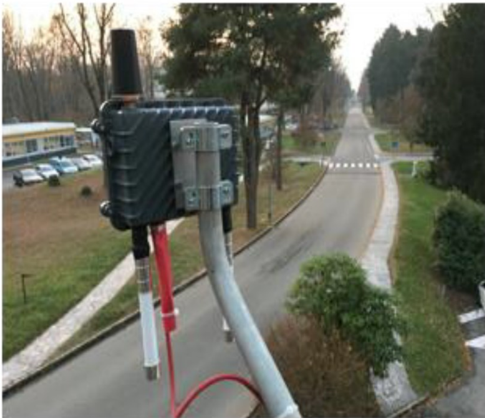
Εικόνα 44: ITS-G5 RSU που αναπτύσσεται στο Test-bed της JRC στην Ispra [92]
