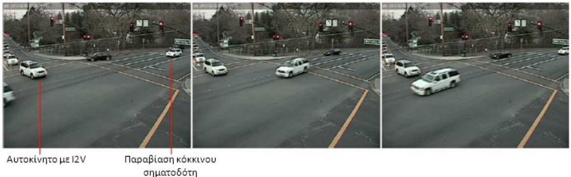
Εικόνα 50: Ανίχνευση παραβίασης ερυθρού σηματοδότη [100]
