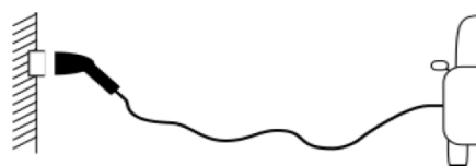
Εικόνα 4-16: Τύπος Α καλωδίου φόρτισης για τη σύνδεση των ηλεκτρικών οχημάτων με το ηλεκτρικό δίκτυο [96]
