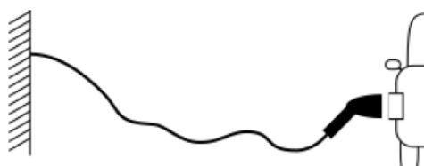
Εικόνα 4-18: Τύπος Γ καλωδίου φόρτισης για τη σύνδεση των ηλεκτρικών οχημάτων με το ηλεκτρικό δίκτυο [96]
