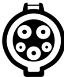
Εικόνα 4-19: Βύσμα φόρτισης ηλεκτρικών οχημάτων J1772 [139]
