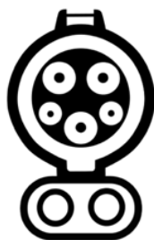
Εικόνα 4-20: Βύσμα φόρτισης ηλεκτρικών οχημάτων J1772 Combo , σύμφωνα με το πρότυπο SAE J1772 [139]
