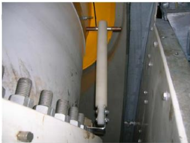
Εικόνα 24: Γείωση μεταξύ πτερυγίων και ατράκτου ( http://apothesis.teicm.gr/xmlui/bitstream/handle/123456789/660/kalantzis.pdf?sequence=1&isAllowed=y )
