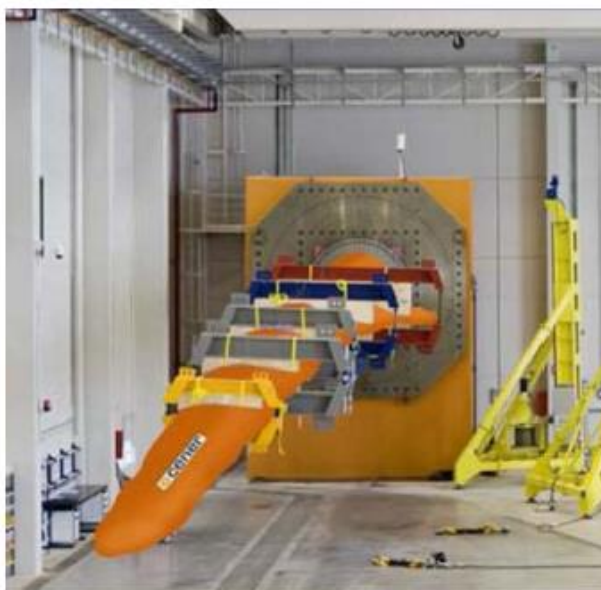
Εικόνα 33: Πτερύγιο ανεμογεννήτριας εξοπλισμένο με αισθητήρες OFBG ( http://www.mhxmeftp.com/windturbines/images/P9.1.pdf )
