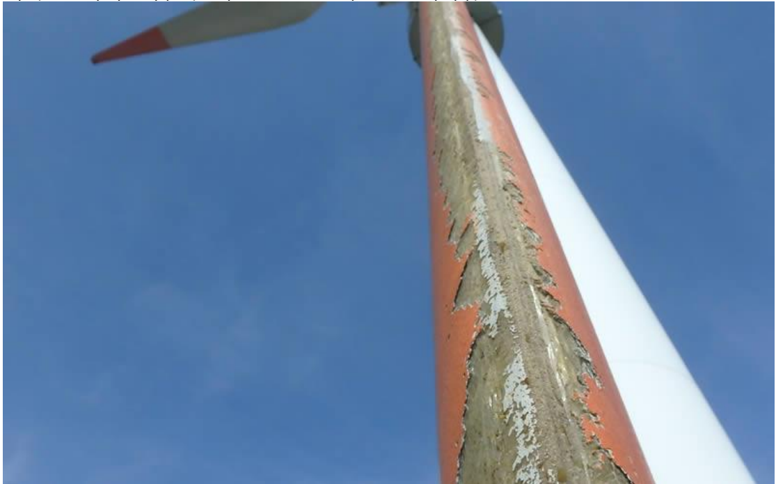
Εικόνα 27: Ζημιά σε λεπίδα ανεμογεννήτριας από πρόσκρουση χαλαζιού ( https://armouredge.com/leading-edge-erosion/ )
