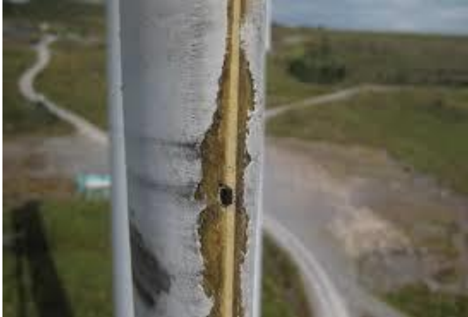
Εικόνα 28: Ζημιά σε λεπίδα ανεμογεννήτριας από πρόσκρουση χαλαζιού (Kensche,2006)
