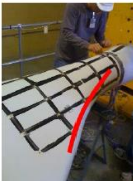
Εικόνα 33: Πτερύγιο ανεμογεννήτριας εξοπλισμένο με αισθητήρες OFBG ( http://www.mhxmeftp.com/windturbines/images/P9.1.pdf )
