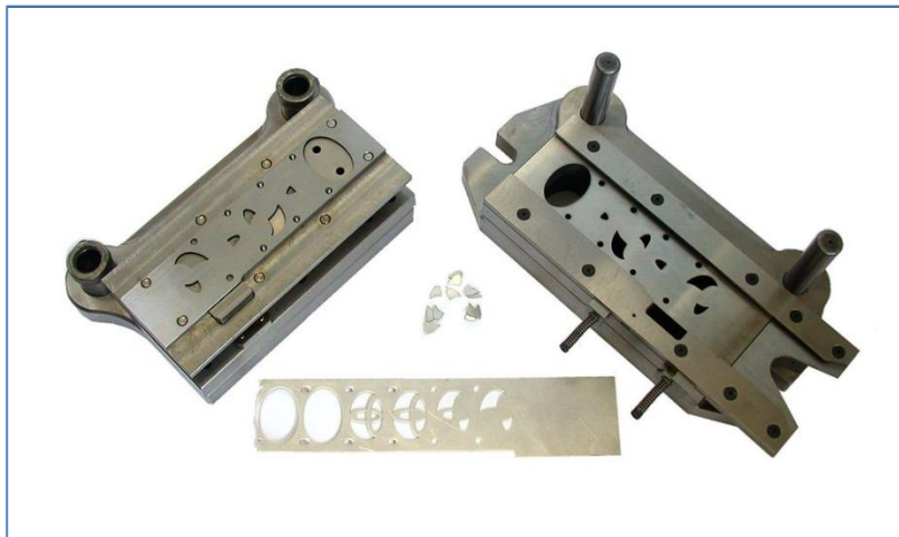
Εικόνα 18: Μεταλλικό Καλούπι και απόκομμα μεταλλικής ταινίας 77
