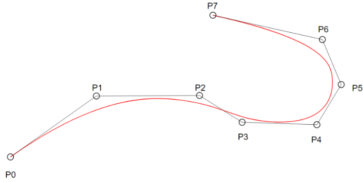
Σχήμα 2: Καμπύλη B-SPLINE 3 ου βαθμού αποτελούμενη από 8 σημεία ελέγχου.
