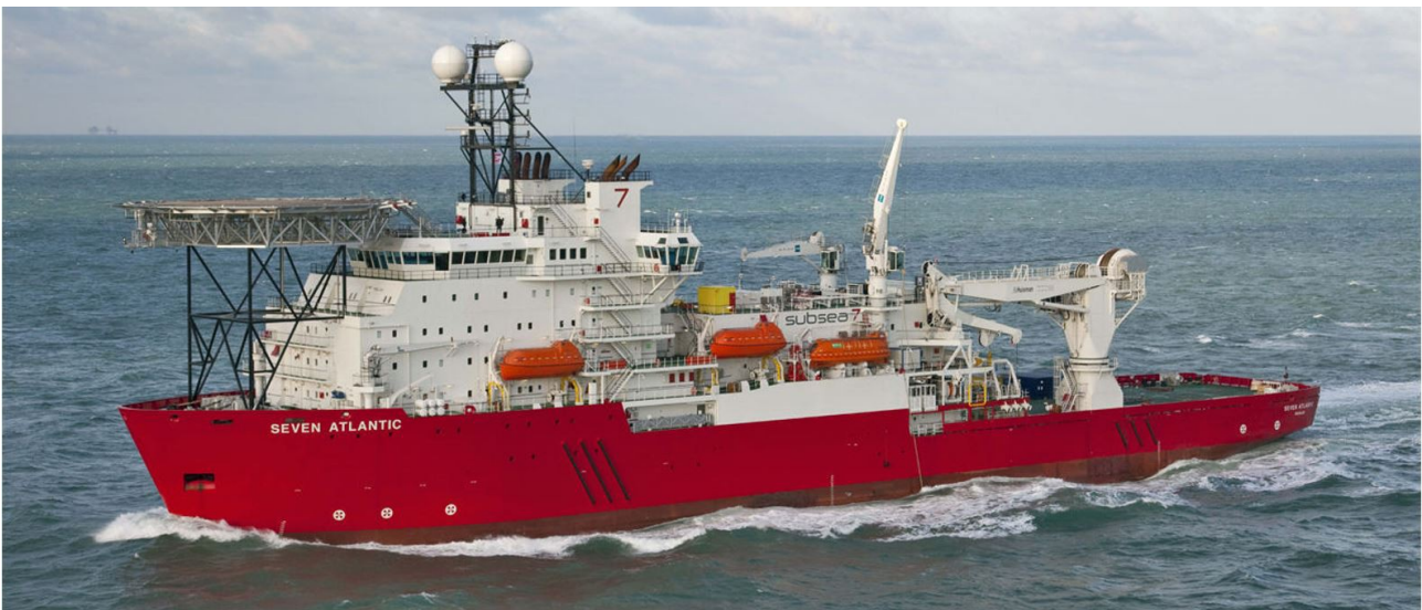
Εικόνα 2: Το πλοίο υποστήριξης καταδύσεων DSV Seven Atlantic (www.royalihc.com)
