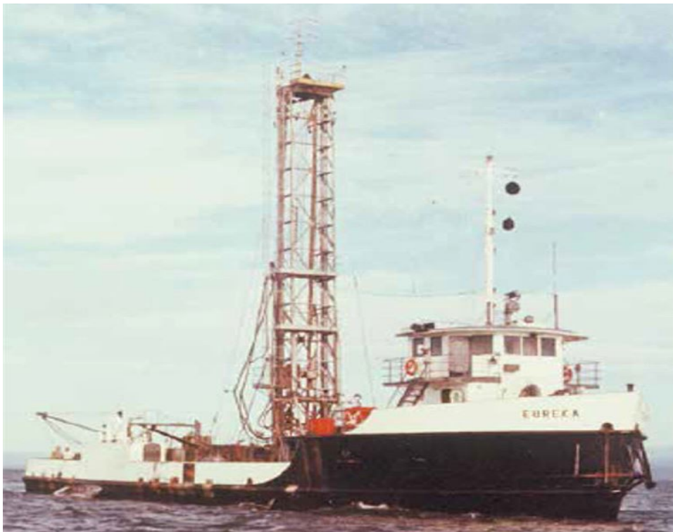
Εικόνα 4: Το Eureka (1961) ήταν το πρώτο πλοίο στον κόσμο με τεχνολογία αυτόματης τοποθέτησης. (Morten Breivik, www.researchgate.com )
