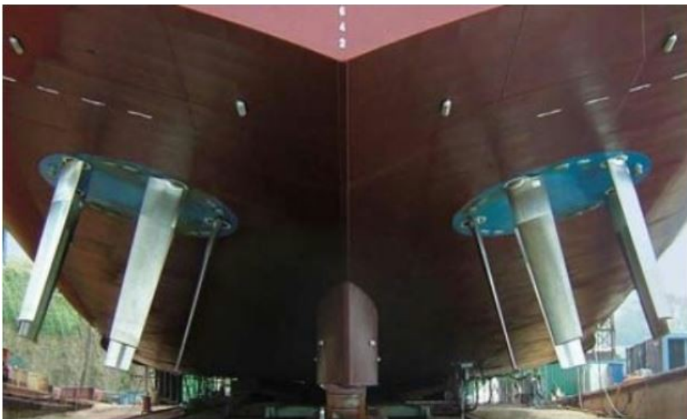
Εικόνα 13: Προωθητές τύπου Voith-Schneider. ( www.boschrexroth.com )
