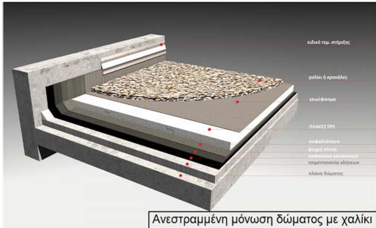
Εικόνα 3.25 Ανεστραμμένη θερμομόνωση( πηγή: http://www.reaktor.gr/ )
