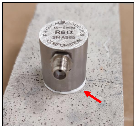
Σχήμα 4.12 Πιεζοηλεκτρικός αισθητήρας ΑΕ τύπου R6a Το κόκκινο βέλος δείχνει το λεπτό φιλμ σιλικόνης στη διεπαφή δοκιμίου -
