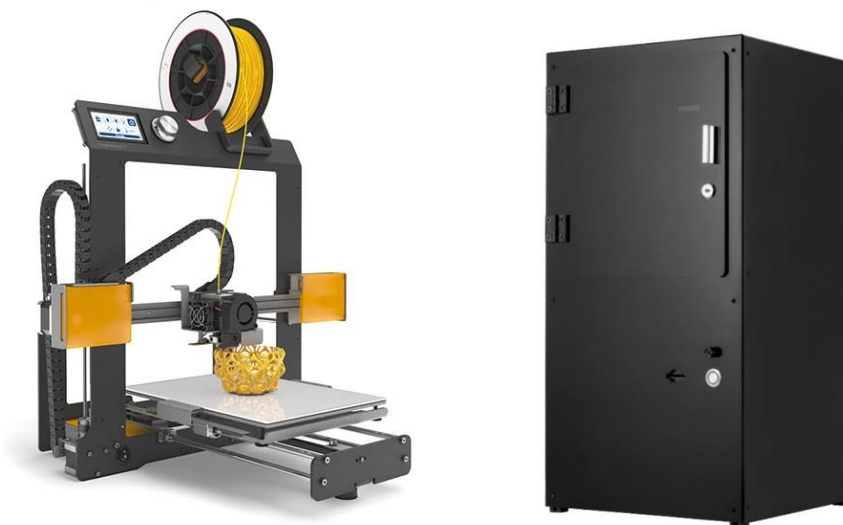
Εικόνα 2.7: Οι εκτυπωτές Prusa i3 Hephestos 2 και Moai Laser SLA Printer
