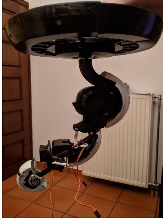
Εικόνα 2.14: Ένωση βάσης και σώματος της GLaDOS
