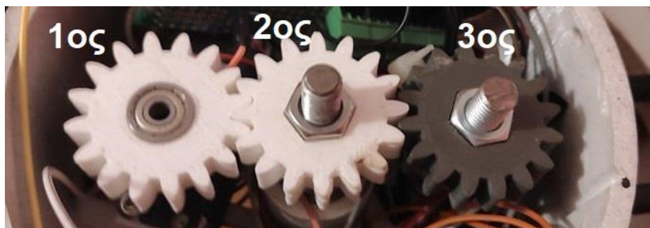
Εικόνα 2.11: Οι 3 περιστροφικοί άξονες στη βάση
