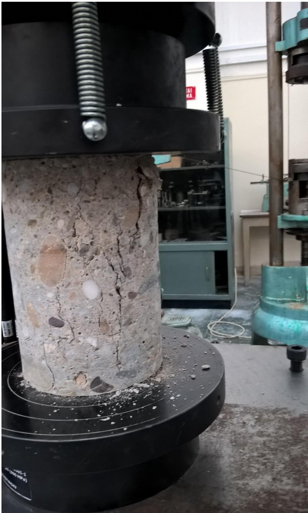
Εικόνα 23 Δοκίμιο Α μετά τη θραύση.
