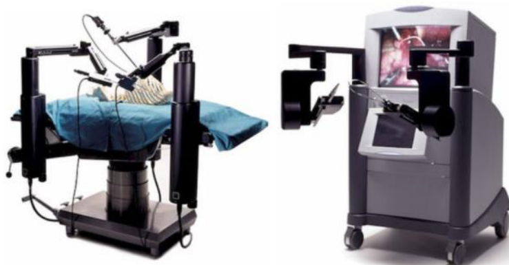
Εικ 1.16 Στην εικόνα παρουσιάζεται ολοκληρωμένα το ρομποτικό σύστημα Zeus. Στα αριστερά είναι οι βραχίονες του ρομποτικού συστήματος (slave) και στα δεξιά η χειρουργική κονσόλα (master) ( Πηγή )
