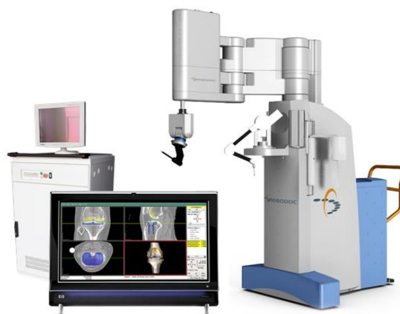
Εικ 1.6 Ρομποτικό σύστημα Robodoc (Πηγγή)
