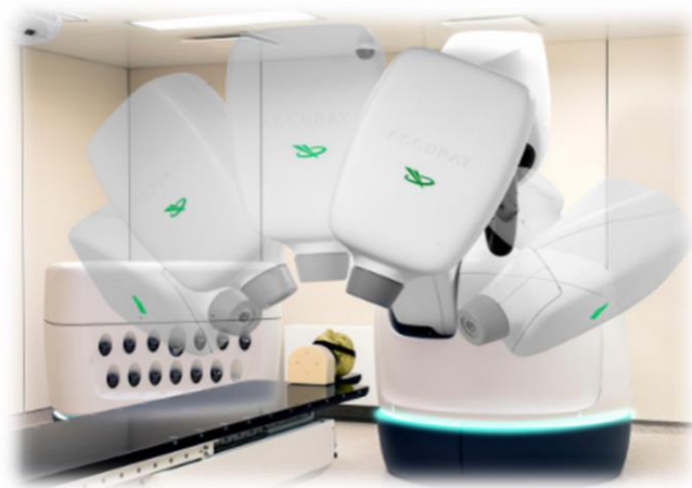
Εικ 1.14 Κίνηση του συστήματος CyberKnife κατά την διάρκεια λειτουργίας ( Πηγή )
