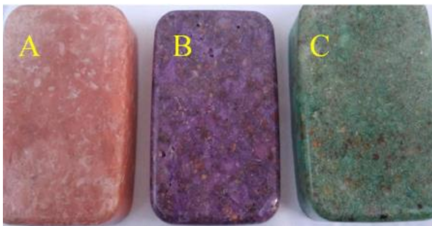
Εικόνα 7.6 Αισθητική των πολυμερών σκυροδεμάτων σε διαφορετικές περιεκτικότητες ΑΑΓ, (α) 100% περιεκτικότητα, (β) 50% περιεκτικότητα, (γ) 30% περιεκτικότητα Πηγή: Zegardo, B et al. (2018)
