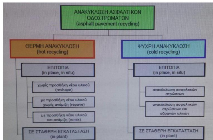
Εικόνα 4.1 Μορφές ανακύκλωσης ασφαλτικών οδοστρωμάτων
