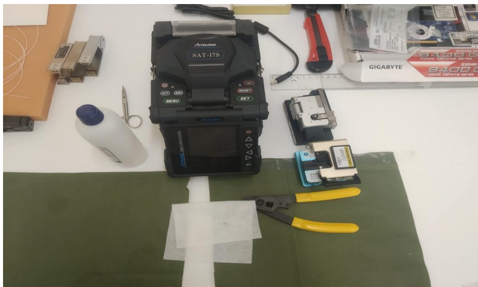
Εικόνα 2.1: Εξοπλισμός συγκόλλησης ινών του εργαστηρίου
