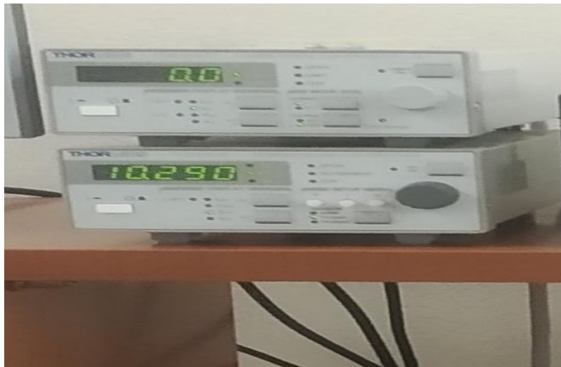
Εικόνα 2.5: Controllers ρεύματος και θερμοκρασίας Laser ημιαγωγού
