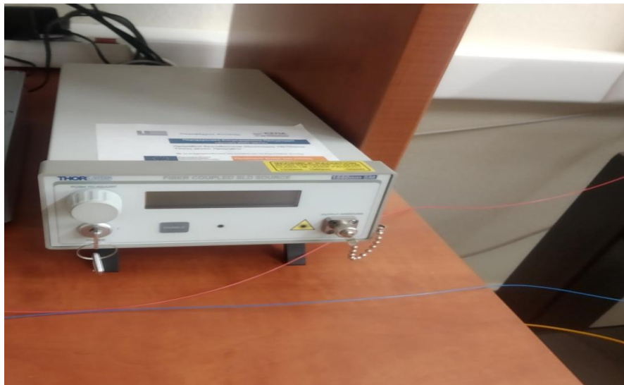
Εικόνα 2.7 Πηγή SLD (Semiconductor Laser Diode)
