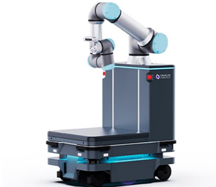
Εικόνα 18 Παράδειγμα τοποθέτησης ρομποτικού βραχίονα πάνω σε κινητό βιομηχανικό ρομπότ, Enabled Robotics - ER-FLEX, της εταιρείας MiR [35].
