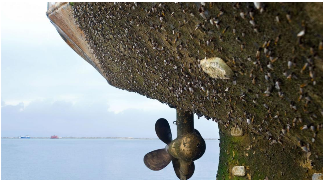
Εικόνα 2. Χαρακτηριστικό παράδειγμα του φαινομένου της βιοσυσσώρευσης σε πλοίο μεταφοράς ξηρού φορτίου
