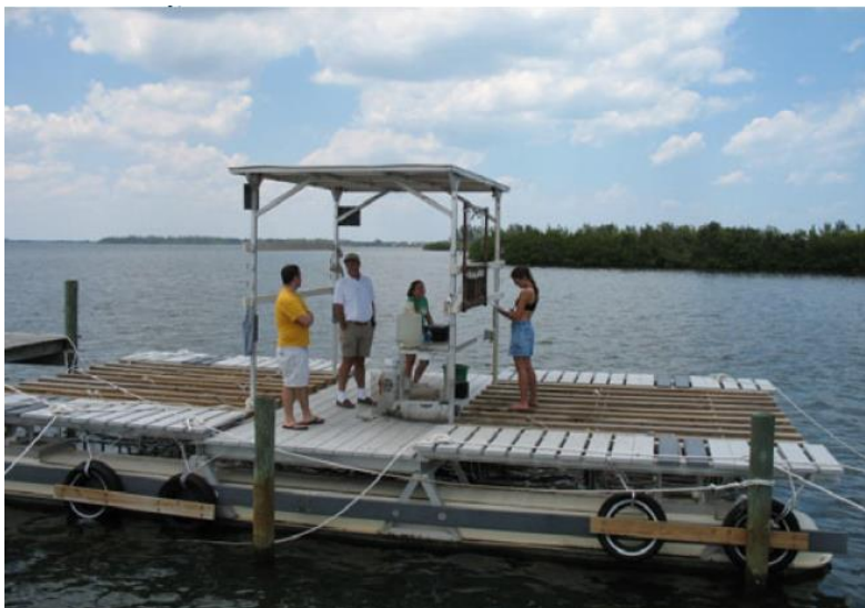
Εικόνα 28. Εγκατάσταση για δοκιμή βύθισης σε στατικές συνθήκες.
