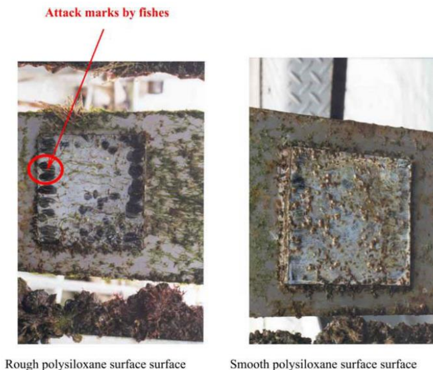
Εικόνα 63. Αποτελέσματα δοκιμών πεδίου μετά από 1 μήνα εμβάπτισης των δοκιμών με τραχιά και λεία επιφάνεια πολυσιλοξάνης.
