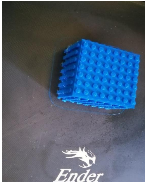
Εικόνα 177: Τρισδιάστατη εκτύπωση ενεργητικών εξαρτημάτων, Creality Ender V2.
