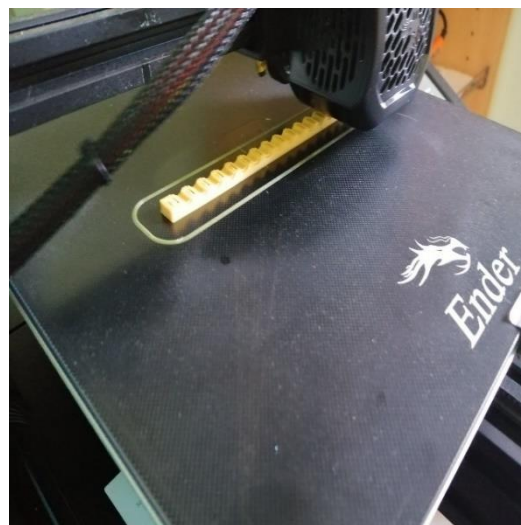
Εικόνα 163: Τρισδιάστατη εκτύπωση παθητικών εξαρτημάτων, Creality Ender V2
