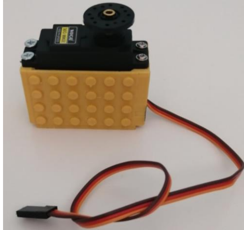
Εικόνα 178: Servo MG996R, Προώψη.
