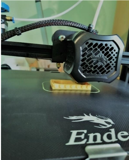
Εικόνα 166: Τρισδιάστατη εκτύπωση ενεργητικών εξαρτημάτων, Creality Ender V2.
