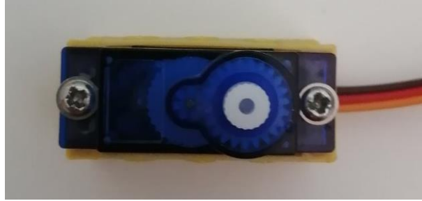
Εικόνα 184: Servo SG90, Κάτοψη.
