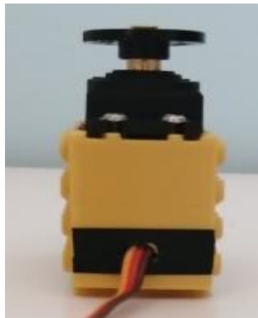
Εικόνα 180: Servo MG996R, Δεξιά Πλάγια Όψη.
