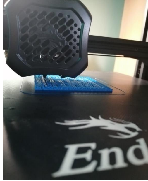
Εικόνα 174: Τρισδιάστατη εκτύπωση ενεργητικών εξαρτημάτων, Creality Ender V2.
