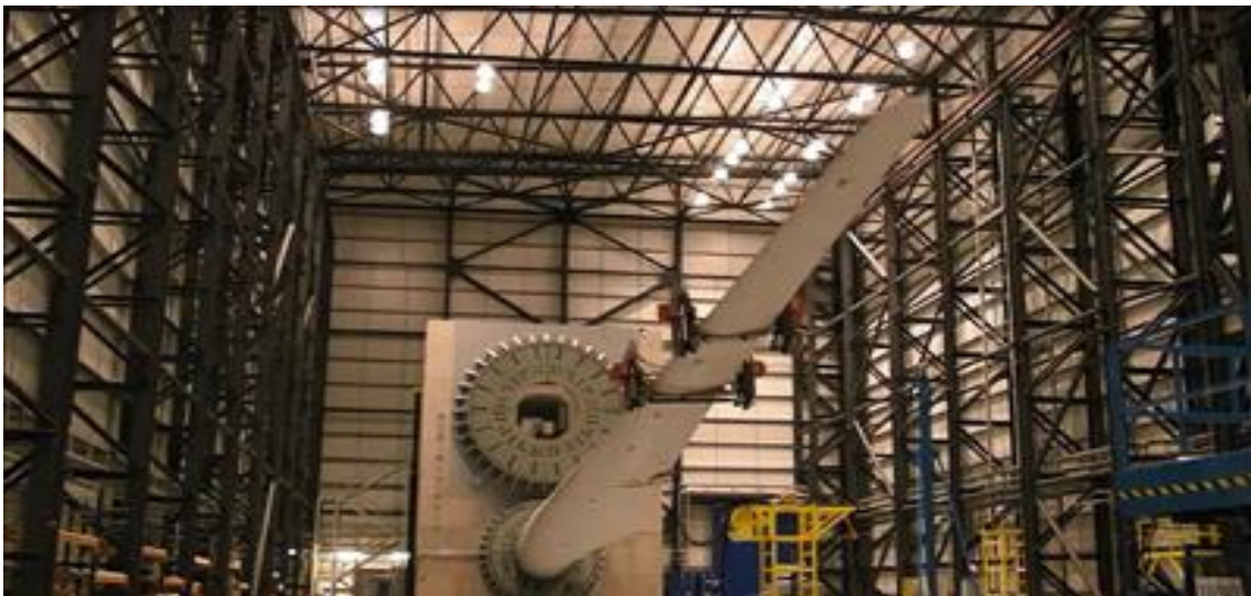
Εικόνα 26: Δοκιμή ελέγχου λεπίδας της ανεμογεννήτριας
