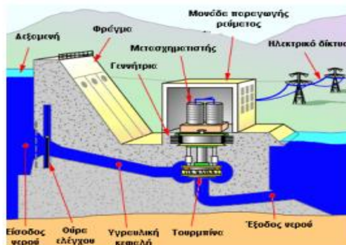
Εικόνα 5. Η παραπάνω φωτογραφία παρουσιάζει τα βασικά μέρη ενός μικρού υδροηλεκτρικού έργου (Πηγή) : Ρυθμιστική Αρχή Ενέργειας
