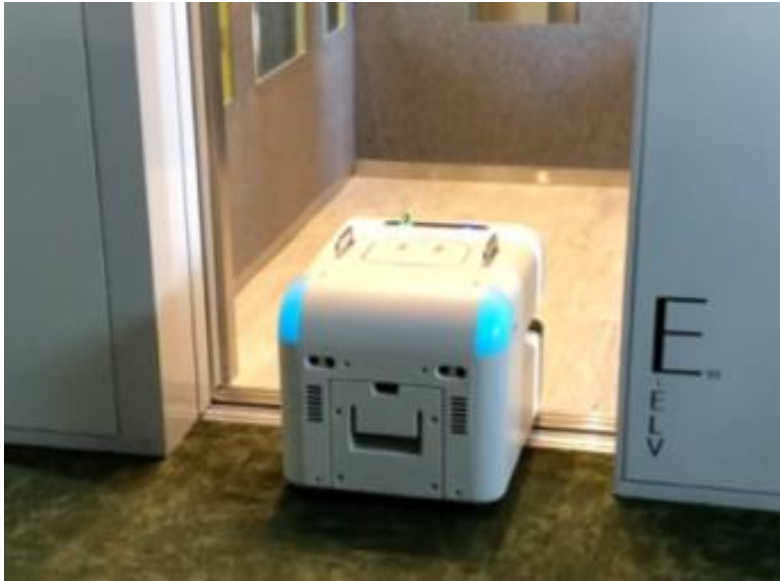
Εικόνα 28-Αυτόνομο ρομπότ καθαρισμού
