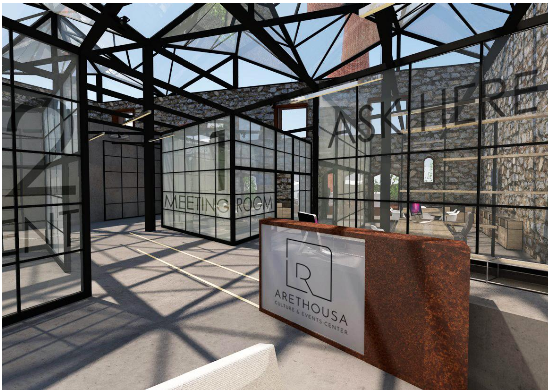
4.10 Η χρήση γυαλιού ηλιακού ελέγχου στην οροφή της διοίκησης (ΚΤ.4).
