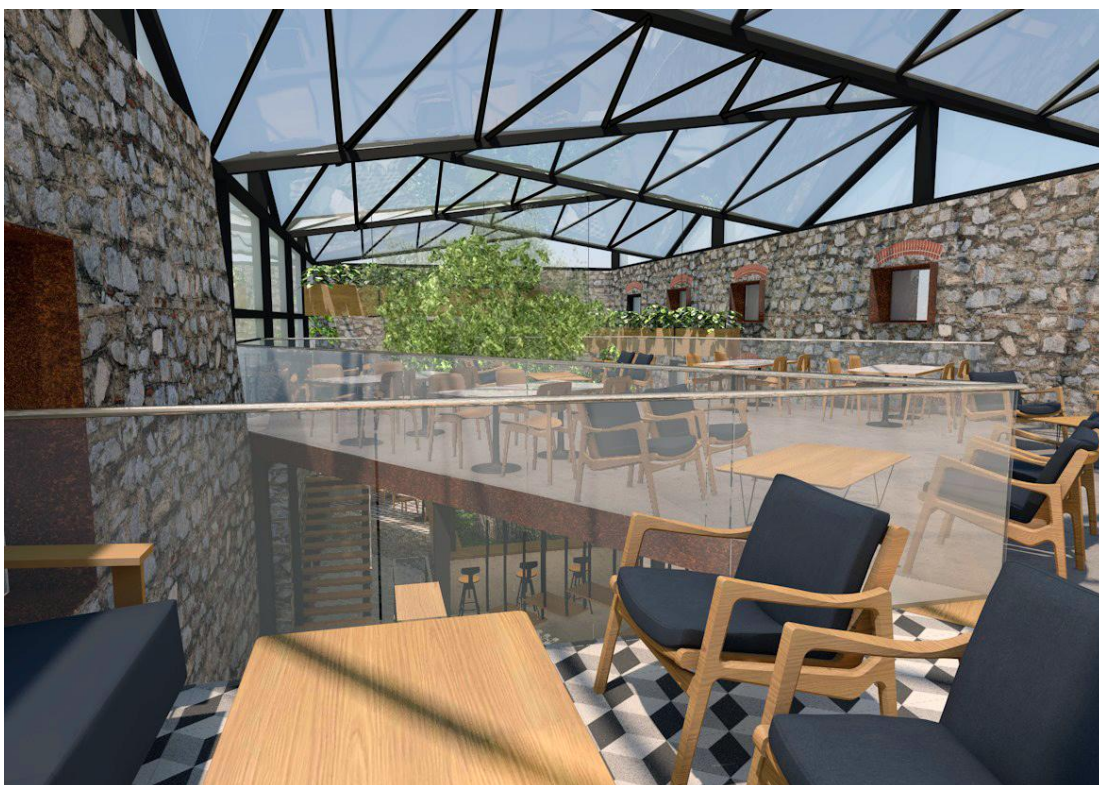
4.11 Η χρήση γυαλιού ηλιακού ελέγχου στην οροφή του café (ΚΤ.4).
