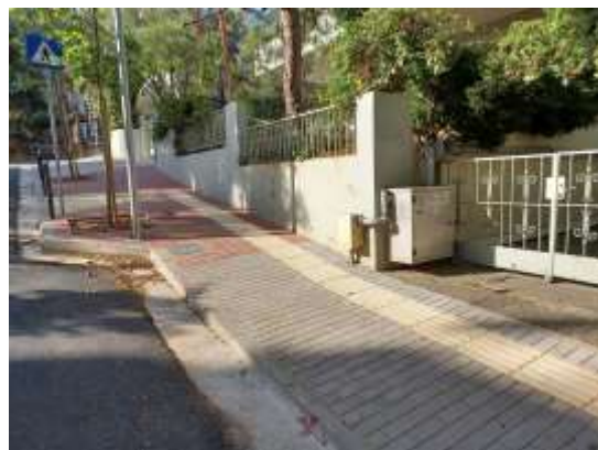
Εικόνα 8.56: Σημειακή διαπλάτυνση πεζοδρομίου, όδευση τυφλού, ράμπα ΑΜΕΑ, υποβιβασμός πεζοδρομίου στο σημείο εισόδου- εξόδου ιδιωτικής θέσης στάθμευσης.
