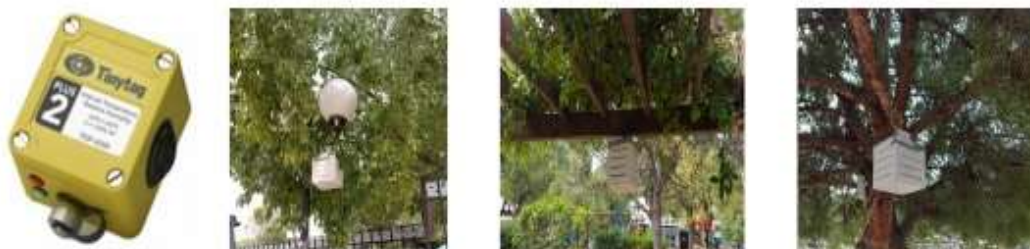
Εικόνα 5. Όργανο μέτρησης Tinytag Plus2 TGP-4017.
