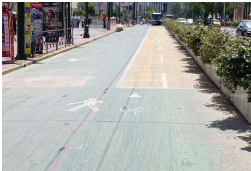
Εικόνα 4.5: Λωρίδες κυκλοφορίας στην οδό Πανεπιστημίου. Λωρίδα πεζού, ποδηλάτου και δεξιά μετά το διαχωρισμό με τη φύτευση λωρίδα κυκλοφορίας οχημάτων.
