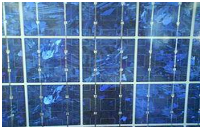
Εικόνα 1.8: Φωτοβολταϊκά στοιχεία κατασκευασμένα από πολυκρυσταλλικό πυρίτιο
