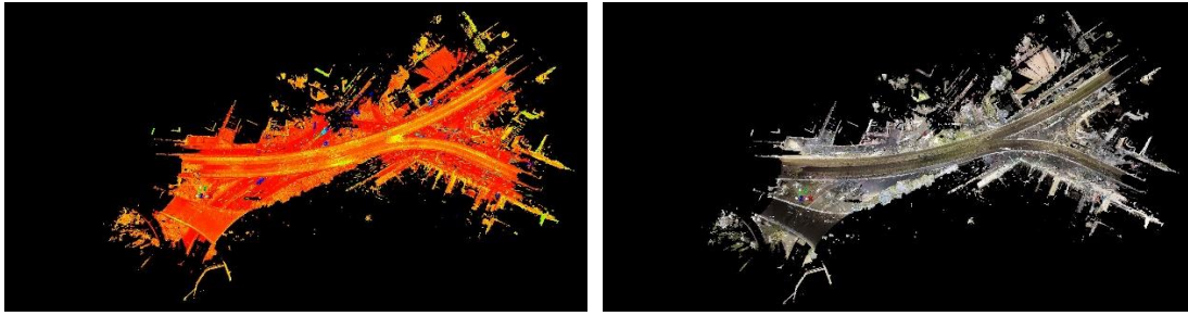
Εικόνα 13 Dense Cloud γεφυρών σε θερμική (αριστερά) και RGB (δεξιά) απεικόνιση.
