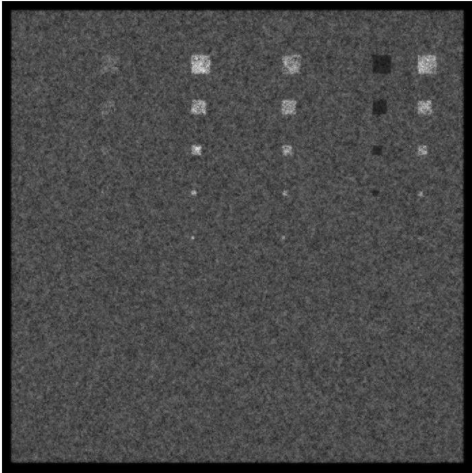
Εικόνα 10 - Εικόνα ενέργειας 18keV , 50.000.000 φωτόνια/mm 2 , πάχος δομών 0.1cm
