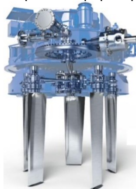
Εικόνα 1.3. Σύστημα πρόωσης πλοίου (Voith-Scheider) [3, fig.1]
