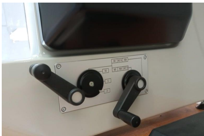
Εικόνα 3.3: Λεπτομέρεια του μηχανήματος σκληρότητας Hardness Testing Machine Type 8187.5 lkn & 9150 lkn (Indentec, UK), μετά από τις σχετικές ρυθμίσεις στα 3kgf.
