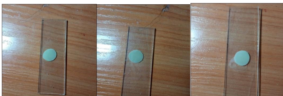
Εικόνα 3.8: Οι ρητίνες FiltekZ550, Evetric, ESTELITE ΣQUICK (από τα αριστερά προς τα δεξιά) μετά την έκθεση τους κάτω από λάμπα 8000 lux για 60sec.
