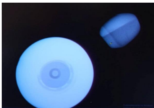
Εικόνα 3.15: Συγκριτική λήψη ακτινογραφίας δείγματος τιτανίου (αριστερά) και ρητίνης Filtek Z550 (δεξιά).
