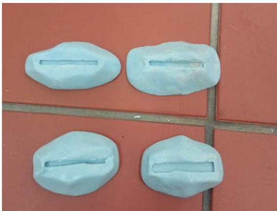
Εικόνα 3.10: Καλούπια ρητινών κατασκευασμένα από σιλικόνη
