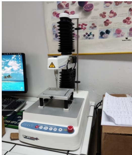
Εικόνα 5.13: Αναλυτής υφής Texture Analyser - TA.XT.Plus
