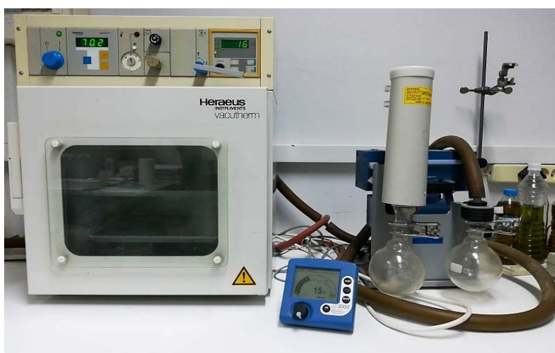
Εικόνα 5.10: Φούρνος κενού, Heraeus Instruments VT 602.
