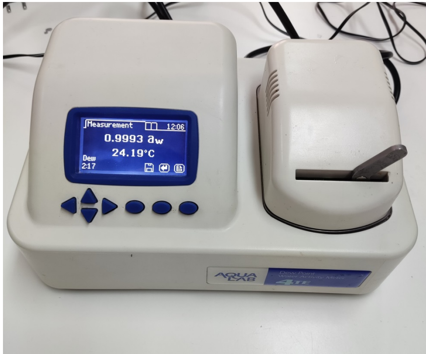
Εικόνα 5.5: AquaLab Dew Point Water Activity Meter 4TE.
