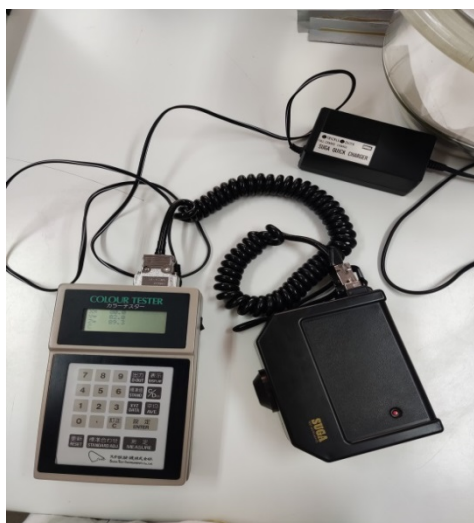
Εικόνα 5.6: Colour Tester Suga Test Instruments Co,Ltd
