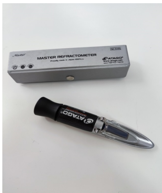
Εικόνα 5.3: Διαθλασίμετρο χειρός 0-90% (ATAGO)
