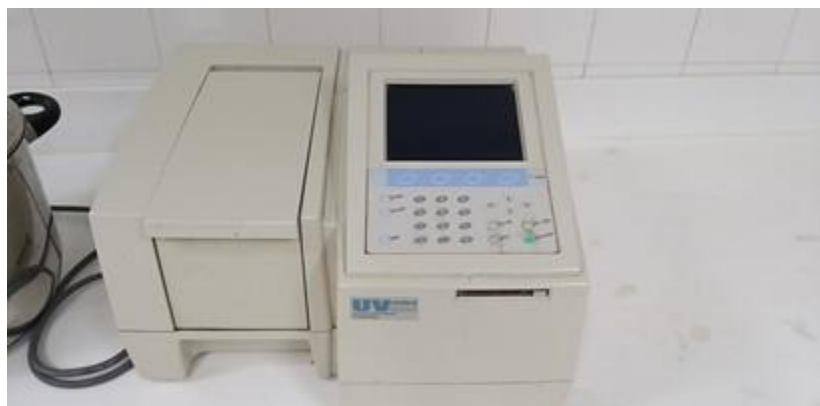
Εικόνα 3.6 Όργανο φασματομέτρησης τύπου UV mini 1240, μοντέλου UV-V.IS spectrophotometer από την εταιρεία Shimadzu Europe
