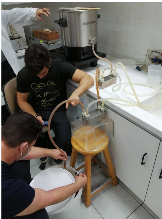
Εικόνα 3.17 Η διαδικασία της ψύξης κατά την παραγωγή της μύρας τύπου brown ale
