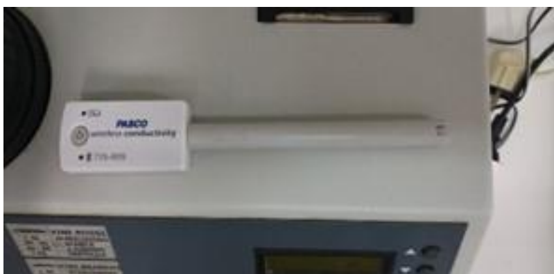
Εικόνα 3.4 Ψηφιακό αγωγιμόμετρο της εταιρείας PASCO
