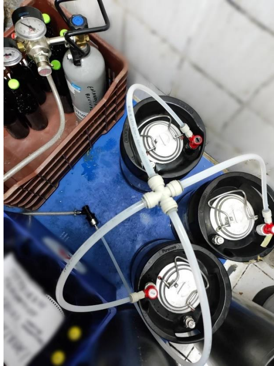
Εικόνα 3.19 Το σύστημα αναθράκωσης των μπυρών σε kegs των 5lt
