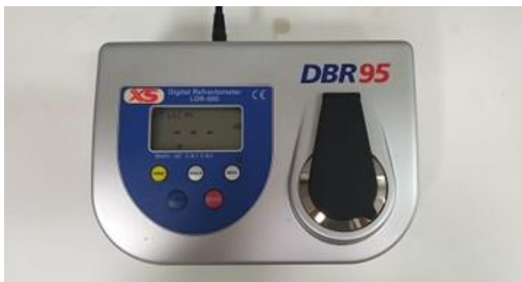
Εικόνα 3.7 Διαθλασίμετρο από την εταιρεία «Giorgio Bormac S.r.l.» μοντέλου XS Instruments LDR-500/DBR95
