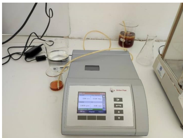
Εικόνα 3.8 Αλκοολόμετρο Alcohol and extract meter Alex 500 της εταιρείας Anton Paar
