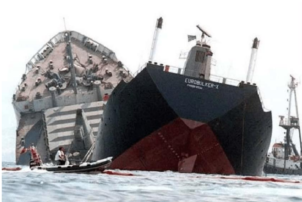
(Εικόνα 1.11) Το bulk carrier «Eurobulker X» στιγμές μετά το διαχωρισμό του πλοίου στην μέση. [Πηγή: www.Eviaportal.gr ]
