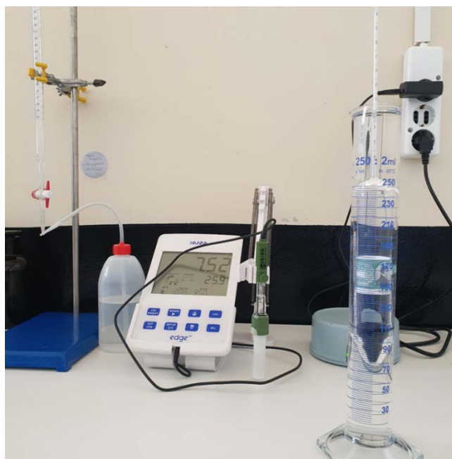
Εικόνα 3.10 Μέτρηση των οίνων με αραιόμετρο και εργαστηριακό pH-μετρο που λειτουργεί με ηλεκτρόδιο (13 Σεπτεμβρίου 2021).
