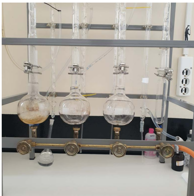
Εικόνα 3.11 Μέτρηση αλκοολικού τίτλου με την μέθοδο της απόσταξης μεθ' υδρατμών σε στήλη απόσταξης.
