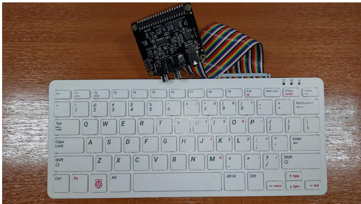
Εικόνα 26: Raspberry Pi 400 και IQaudio Pro DAC+, συνδεδεμένα με 40-Pin ribbon
