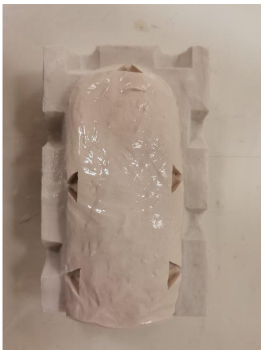
Εικ. 28 Βλέπουμε το στάδιο μετά τη χύτευση του δεύτερου κομματιού της σιλικόνης και προτού χυτευθεί η δεύτερη εσάρπα (2022), Κουβέλη Κωνσταντίνα.
