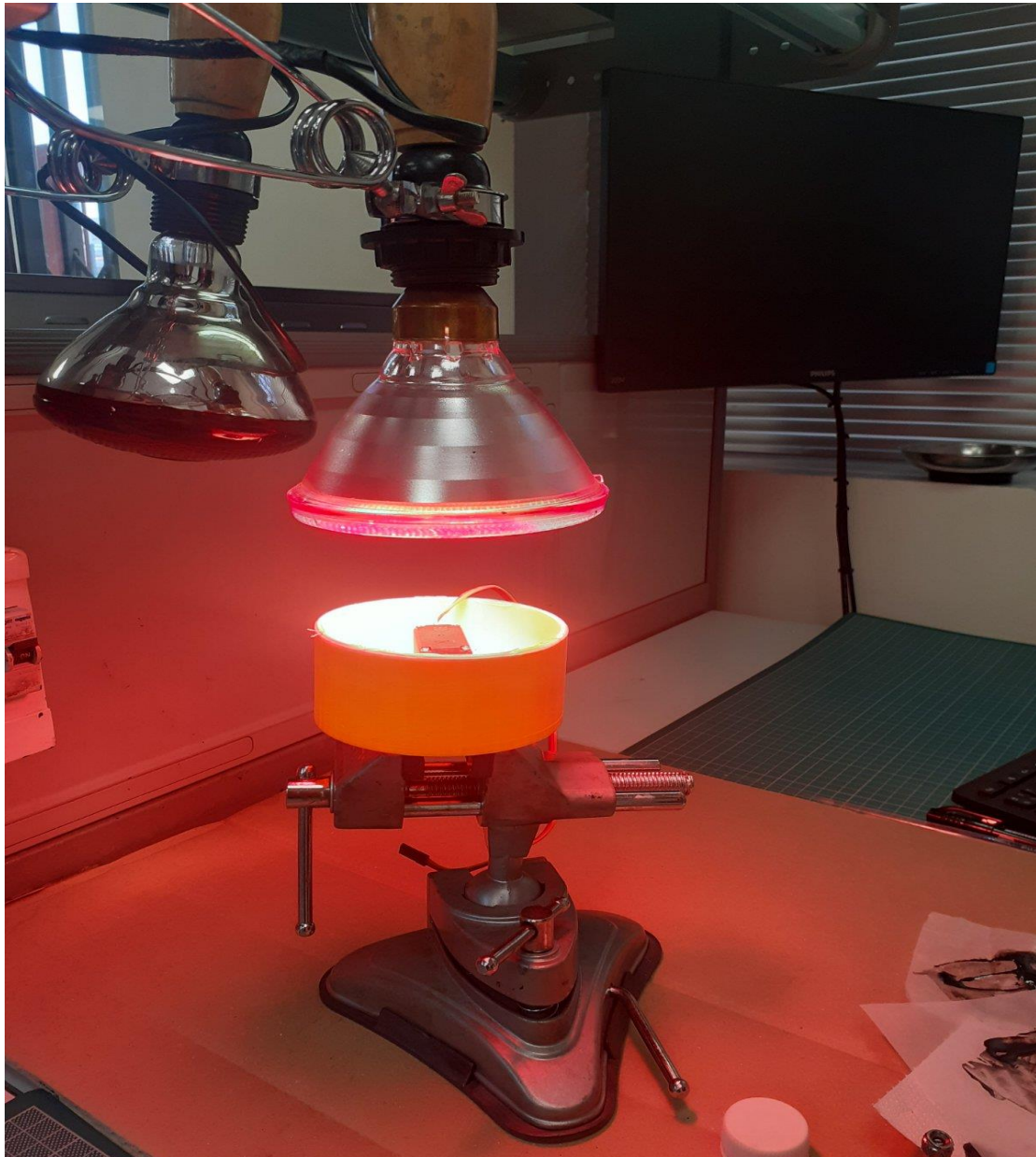
Εικόνα 24: Πολυμερισμός της κόλλας με υπέρυθρη ακτινοβολία
