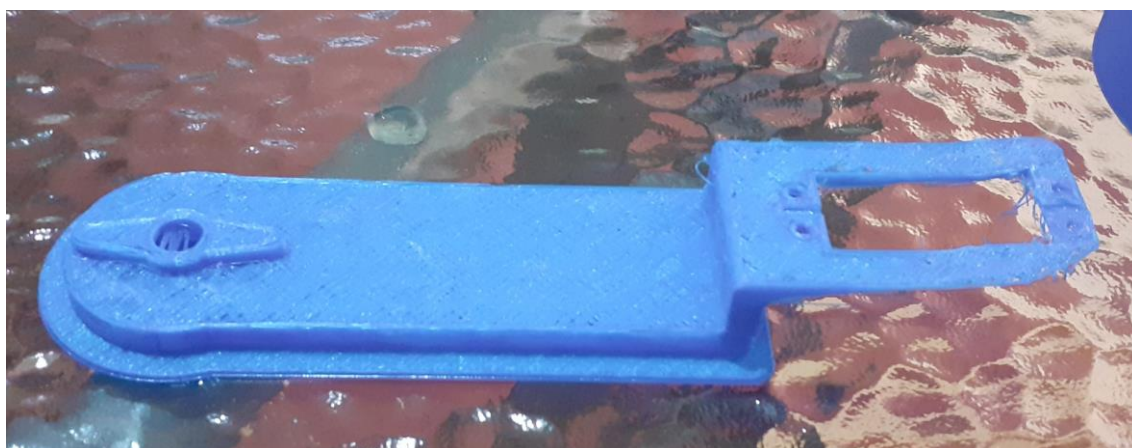
Εικόνα 10: Μοχλός μετάδοσης κίνησης από fast printing
