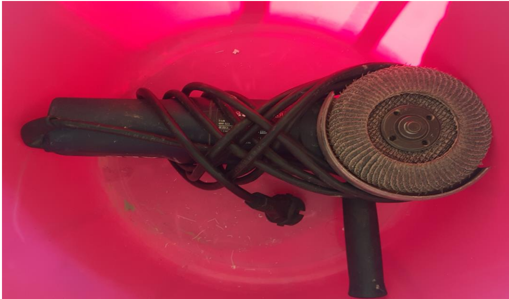
Εικόνα 15: Γωνιακός τροχός με δισκάκι φλαπς λείανσης με σμυρίδι
