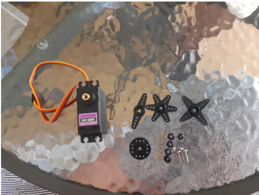
Εικόνα 19: Σερβοκινητήρες MG 996R
