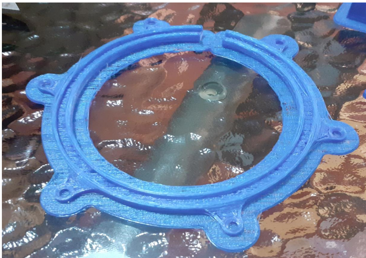
Εικόνα 19: Σύνδεσμος βάσης με οπές από fast printing
