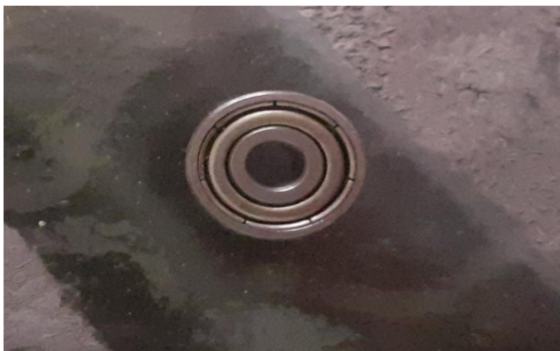
Εικόνα 26: Ρουλεμάν τεσσάρων χιλιοστών
