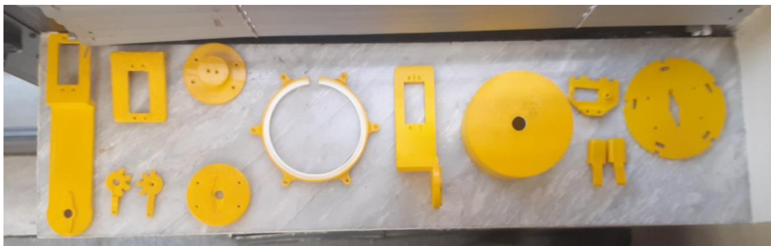
Εικόνα 16: Τα κομμάτια ύστερα από τη λείανση και το βάψιμο
