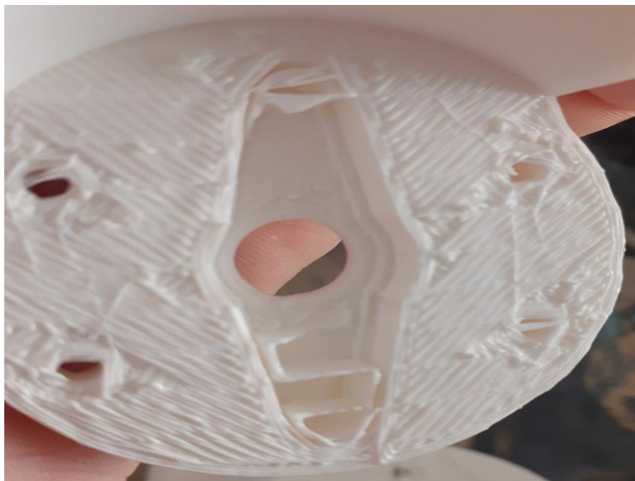
Εικόνα 23: Ενδεικτική εικόνα κομματιού από fast printing
