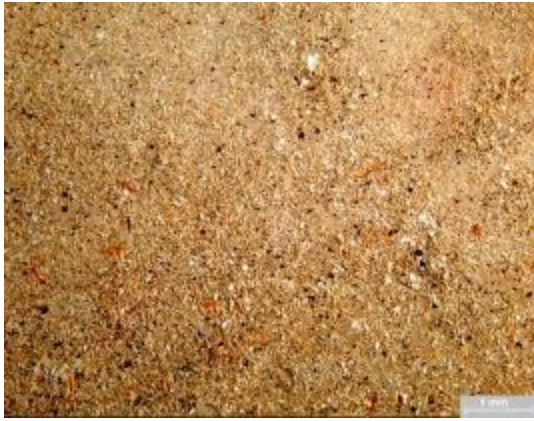
Εικ. 82: Επιφάνεια του δείγματος P1_P στο στερεομικροσκόπιο (x16) (Χατζηαντωνίου © Πα.Δ.Α., Τμήμα Συντήρησης Αρχαιοτήτων και Έργων Τέχνης).
