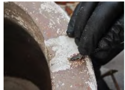
Εικ. 178: Αφαίρεση απόθεσης ελαιοχρώματος με νυστέρι (Χατζηαντωνίου © ΤΑΠΑ).
