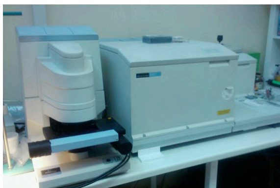
Εικ. 66: Όργανο φασματοσκοπίας υπερύθρου με μετασχηματισμό Fourier (Μπογιατζής Σ. © Πα.Δ.Α., Τμήμα Συντήρησης Αρχαιοτήτων και Έργων Τέχνης).
