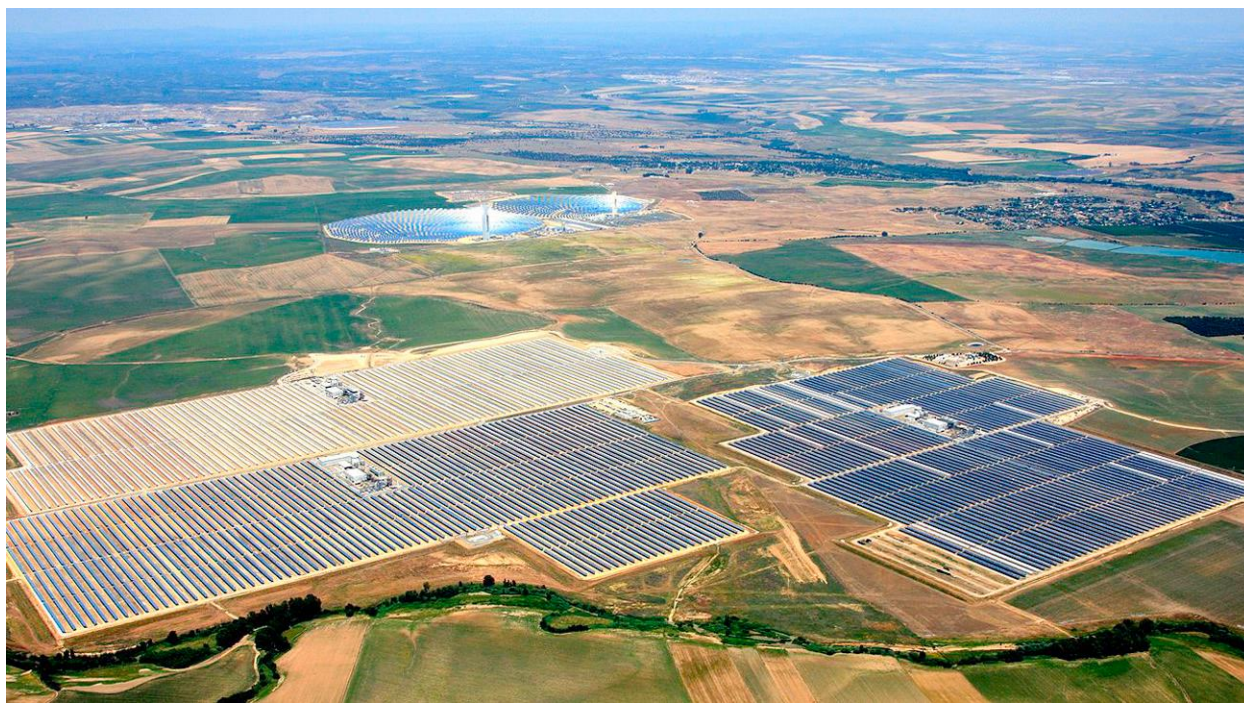
Εικόνα 1.9 - Solnova CSP εγκατάσταση παραβολικών συλλεκτών. (Salahuddin, 2016)
