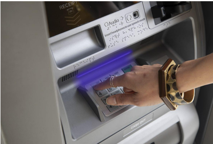
Σχήμα 4.4 Απολύμανση πληκτρολογίων ηλεκτρονικών υπολογιστών με τη χρήση υπεριώδους ακτινοβολίας UVC [23] .
