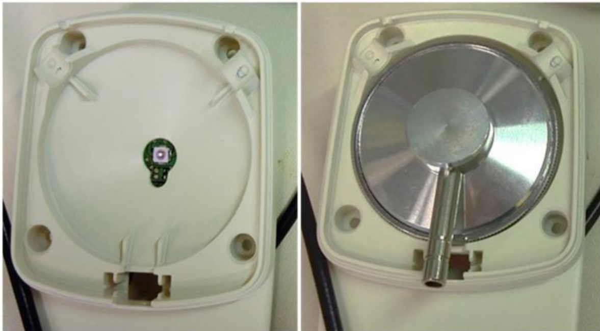
Σχήμα 4.22 Εφαρμογή κεφαλής στο στηθοσκόπιο για τη διαδικασία καθαρισμού με υπεριώδες φως [30] .
