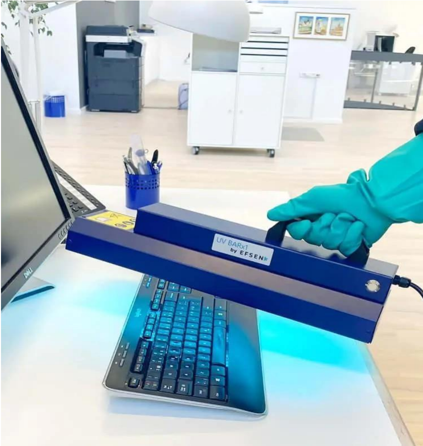
Σχήμα 4.4 Απολύμανση πληκτρολογίων ηλεκτρονικών υπολογιστών με τη χρήση υπεριώδους ακτινοβολίας UVC [23] .
