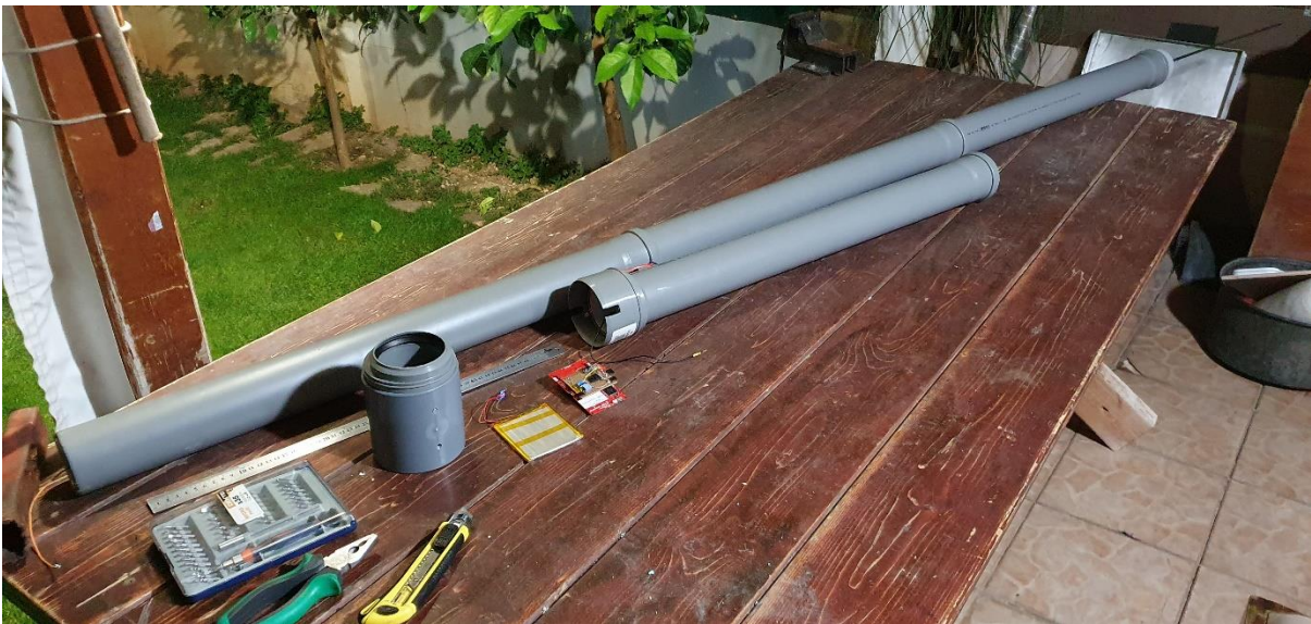
Εικόνα 3.1: Τα τεμάχια του προστατευτικού κελύφους του αισθητήρα
