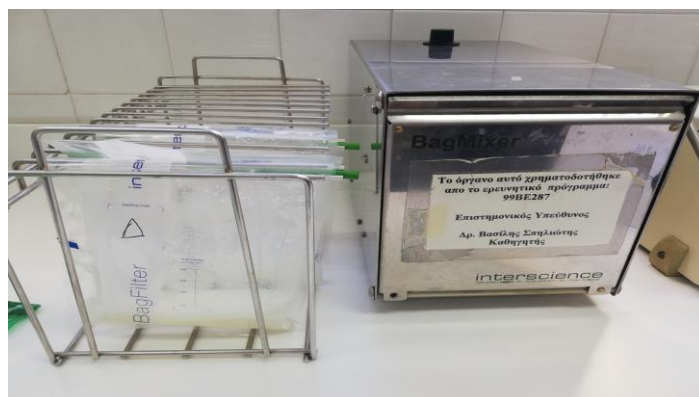
Εικόνα 5.11: Συσκευή Stomacher και Bag Filters με την πρώτη δεκαδική αραιώση των δειγμάτων.
