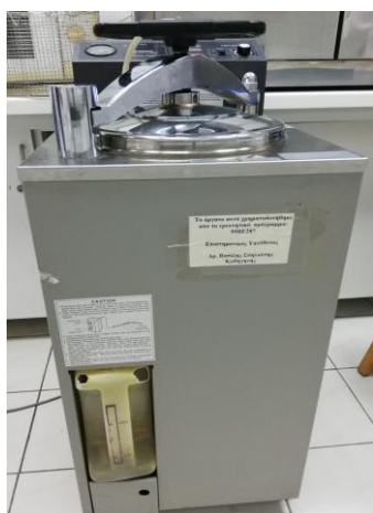
Εικόνα 5.8: Κλίβανος υγρής αποστείρωσης που χρησιμοποιήθηκε.
