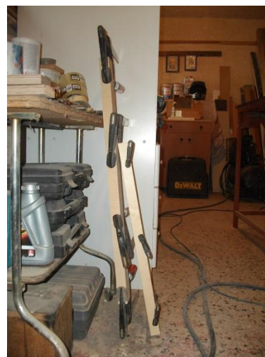
Εικόνα 3-25 Στιγμιότυπο από την ένωση των στηριγμάτων των γραμμικών αξόνων του X και του Y άξονα (εικόνα της γραφούσης)
