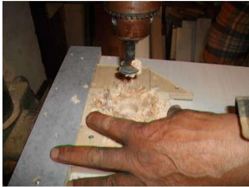
Εικόνα 3-26 Στιγμιότυπο από το τρύπημα των στηριγμάτων των βηματικών κινητήρων (εικόνα της γραφούσης)
