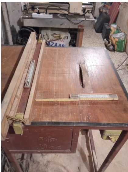
Εικόνα Π- 5 Ρύθμιση τραπεζιού κοπής
