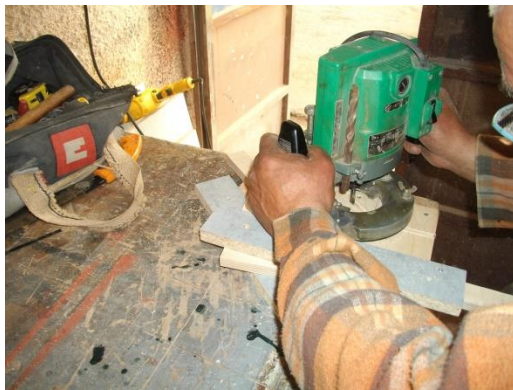
Εικόνα 3-29 Κοπή των στηριγμάτων της γέφυρας με τη χρήση ρούτερ (εικόνα της γραφούσης)
