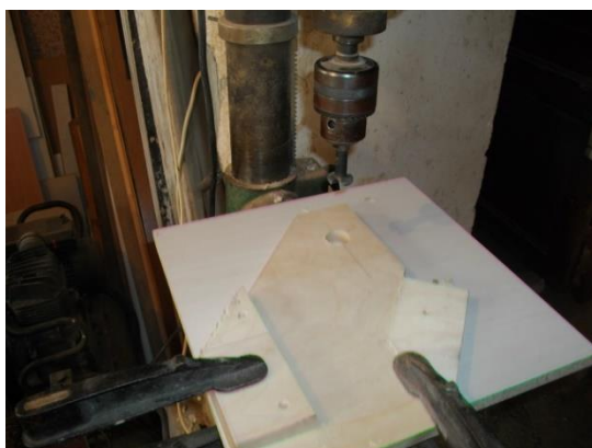
Εικόνα 3-30 Τρύπημα του αριστερού στηρίγματος της γέφυρας (εικόνα της γραφούσης)
