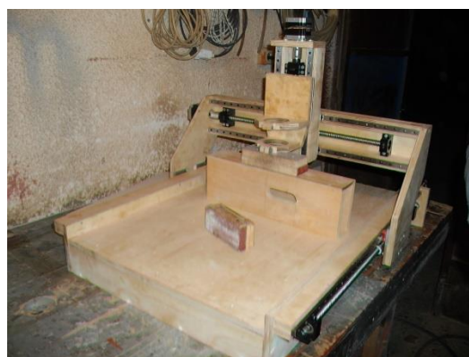
Εικόνα 3-40 Τοποθέτηση των στηριγμάτων για τη συγκράτηση του ρούτερ στη κατασκευή (εικόνα της γραφούσης)
