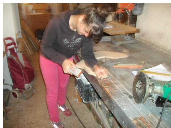
Εικόνα 3- 31 Τρίψιμο ακμών με γυαλόχαρτο μετά την κοπή με το ρούτερ (εικόνα της γραφούσης)
