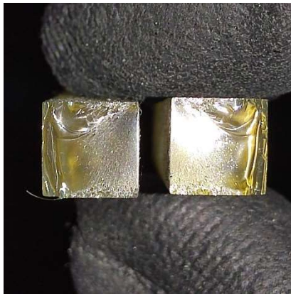
Εικόνα 144 Δοκίμιο 9.3 Σημείο θραύσης
