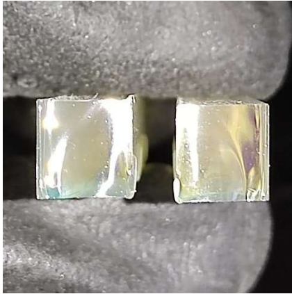
Εικόνα 114 Δοκίμιο 5.1 Σημείο θραύσης
