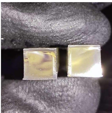
Εικόνα 89 Δοκίμιο 1.5 Σημείο θραύσης
