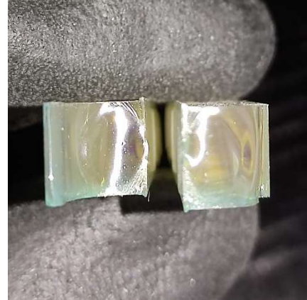
Εικόνα 113 Δοκίμιο 5.2 Σημείο θραύσης
