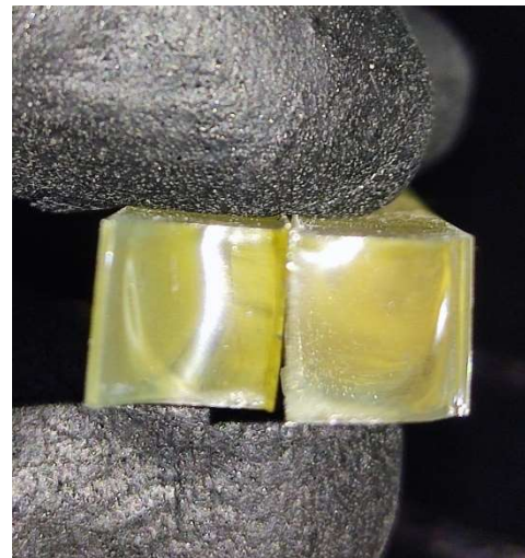
Εικόνα 94 Δοκίμιο 2.4 Σημείο θραύσης
