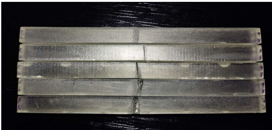
Εικόνα 119 Δοκίμια 6.1-6.5, μετά από την υποβολή τους στην καταπόνηση της κάμψης.
