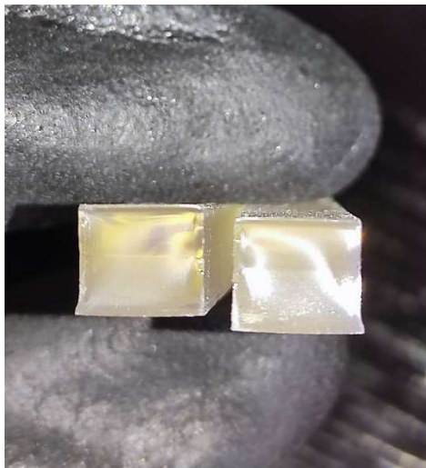
Εικόνα 87 Δοκίμιο 1.3 Σημείο θραύσης
