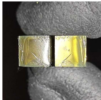
Εικόνα 142 Δοκίμιο 9.2 Σημείο θραύσης
