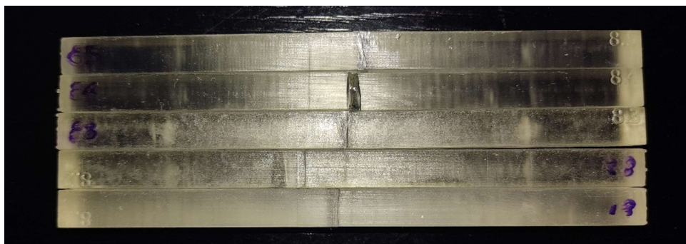
Εικόνα 133 Δοκίμια 8.1-8.5, μετά από την υποβολή τους στην καταπόνηση της κάμψης.
