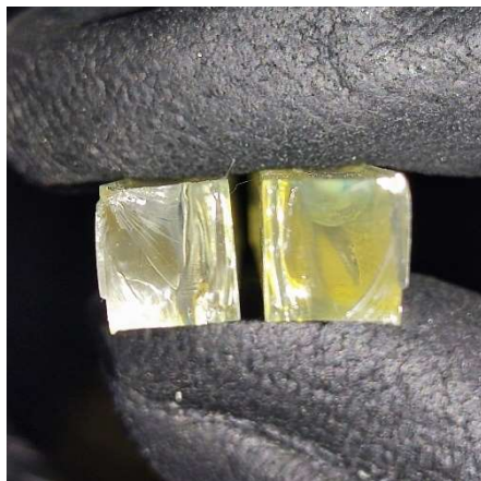
Εικόνα 102 Δοκίμο 3.3 Σημείο θραύσης
