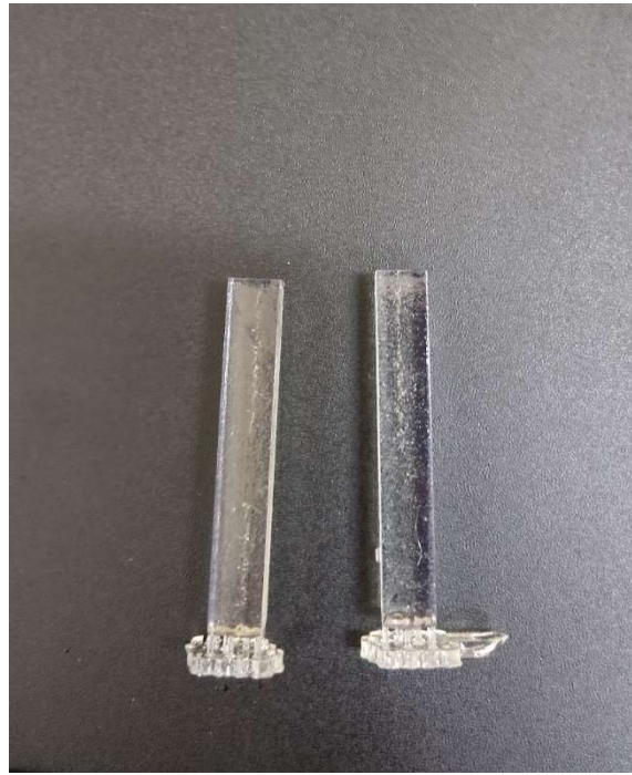
Εικόνα 149 Μη επιτυχής εκτύπωση
