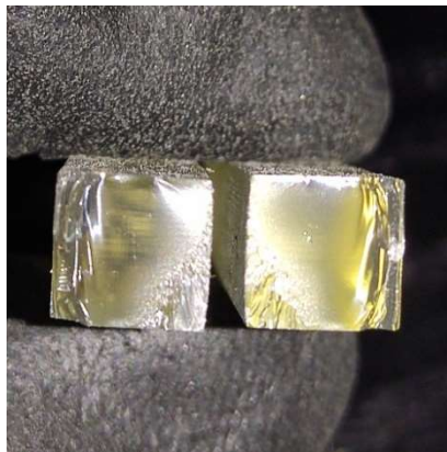
Εικόνα 129 Δοκίμιο 7.3 Σημείο θραύσης
