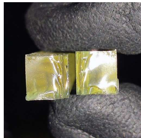
Εικόνα 101 Δοκίμο 3.4 Σημείο θραύσης
