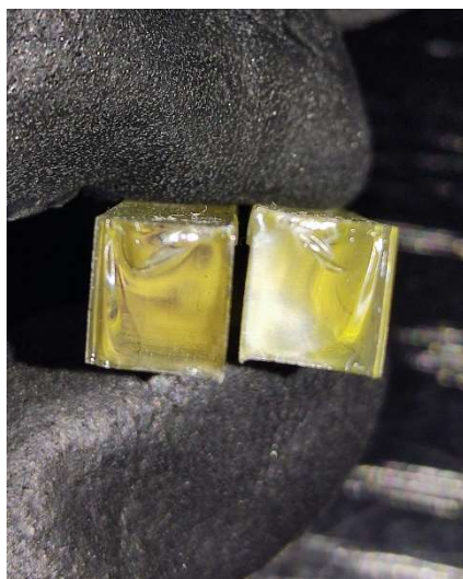
Εικόνα 96 Δοκίμιο 2.5 Σημείο θραύσης
