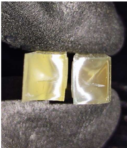
Εικόνα 95 Δοκίμιο 2.3 Σημείο θραύσης
