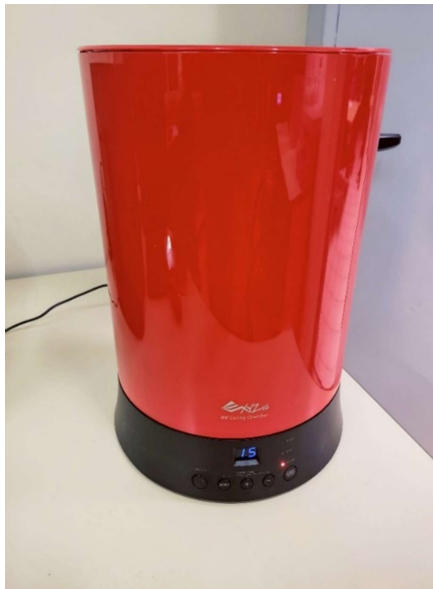
Εικόνα 79 Ο εξοπλισμός που χρησιμοποιήθηκε για την διαδικασία του UV Curing
