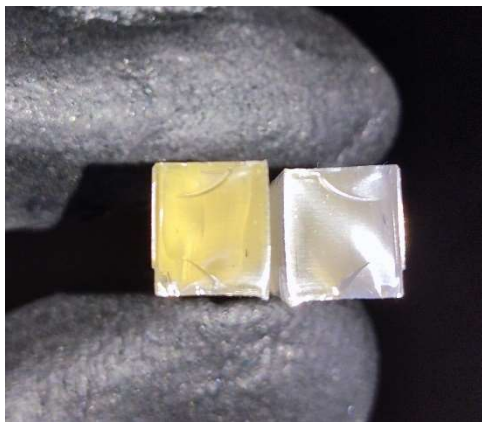
Εικόνα 85 Δοκίμιο 1.1 Σημείο θραύσης
