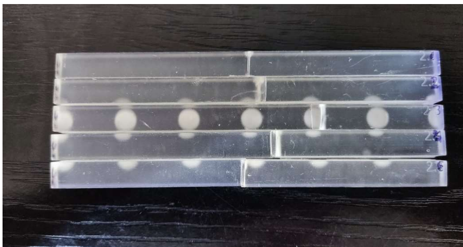
Εικόνα 91 Δοκίμια 2.1-2.5, μετά από την υποβολή τους στην καταπόνηση της κάμψης.
