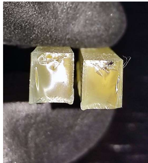
Εικόνα 93 Δοκίμιο 2.2 Σημείο θραύσης
