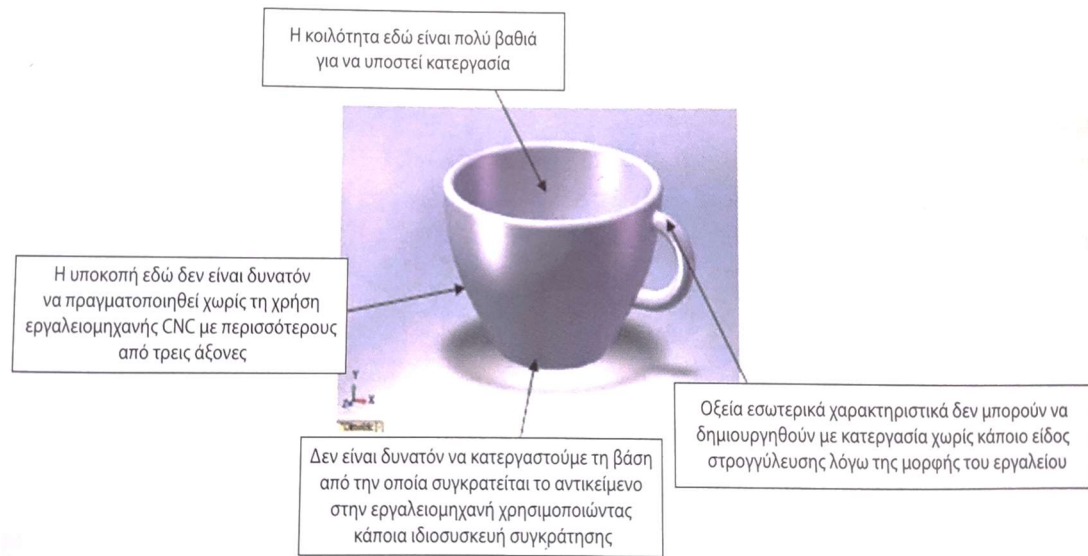
Εικόνα 6 Σημεία που κατά την αφαιρετική κατεργασία θα υπήρχε αδυναμία κοπής. (Ian Gibson, 2017)
