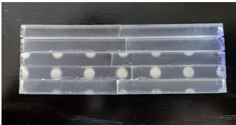
Εικόνα 84 Δοκίμια 1.1-1.5, μετά από την υποβολή τους στην καταπόνηση της κάμψης.
