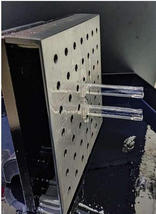
Εικόνα 150 Μη επιτυχής εκτύπωση
