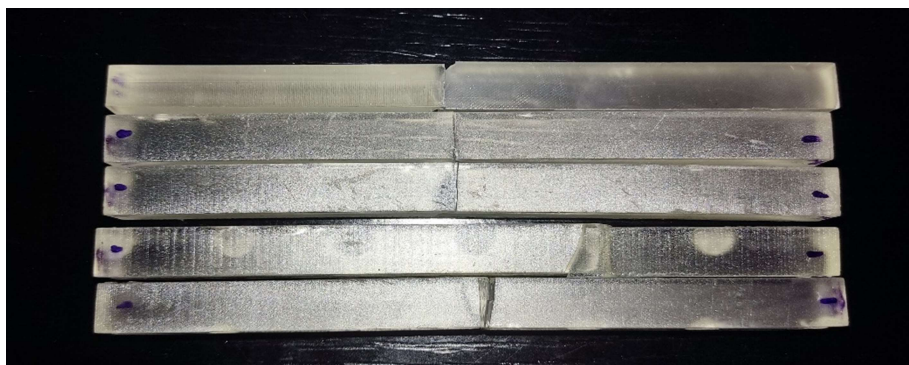
Εικόνα 105 Δοκίμα 4.1-4.5, μετά από την υποβολή τους στην καταπόνηση της κάμψης.
