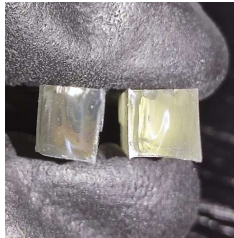
Εικόνα 108 Δοκίμιο 4.4 Σημείο θραύσης
