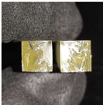
Εικόνα 131 Δοκίμιο 7.5 Σημείο θραύσης
