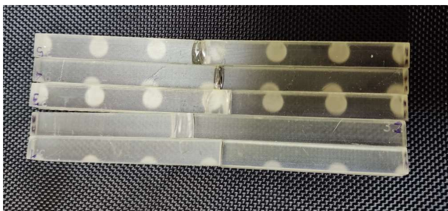
Εικόνα 98 Δοκίμια 3.1-3.5, μετά από την υποβολή τους στην καταπόνηση της κάμψης.
