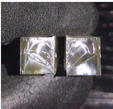
Εικόνα 110 Δοκίμιο 4.5 Σημείο θραύσης
