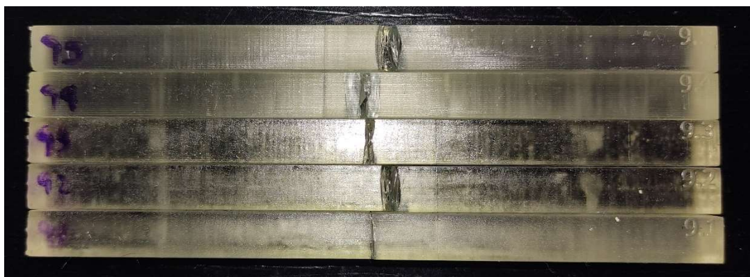
Εικόνα 140 Δοκίμια 9.1-9.5, μετά από την υποβολή τους στην καταπόνηση της κάμψης.
