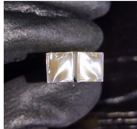
Εικόνα 86 Δοκίμιο 1.2 Σημείο θραύσης
