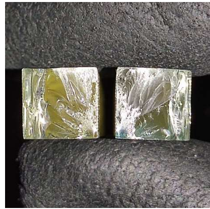
Εικόνα 143 Δοκίμιο 9.4 Σημείο θραύσης
