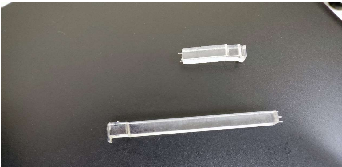
Εικόνα 148 Αδυναμία εκτύπωσης δυο δοκιμών στον άξονα Z
