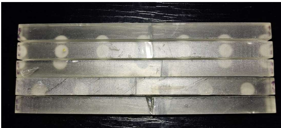
Εικόνα 112 Δοκίμια 5.1-5.5, μετά από την υποβολή τους στην καταπόνηση της κάμψης.
