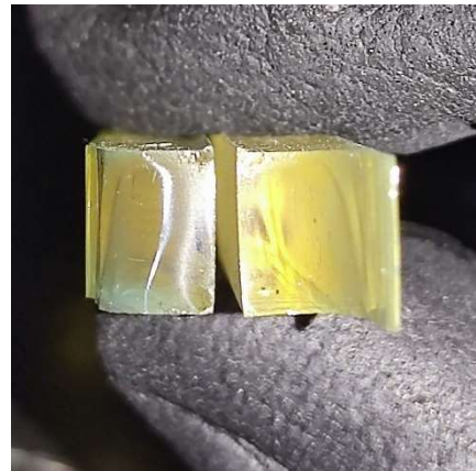
Εικόνα 100 Δοκίμο 3.2 Σημείο θραύσης
