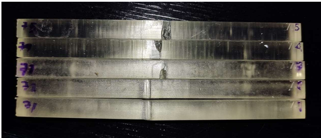
Εικόνα 126 Δοκίμια 7.1-7.5, μετά από την υποβολή τους στην καταπόνηση της κάμψης.
