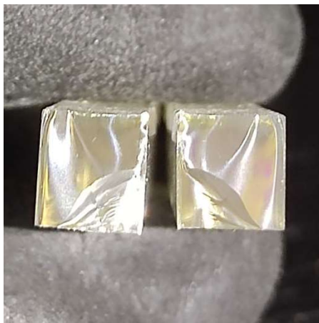
Εικόνα 123 Δοκίμιο 6.3 Σημείο θραύσης
