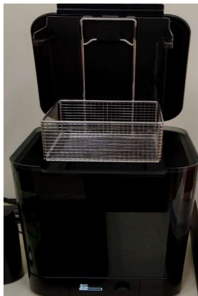
Εικόνα 76 Το form wach που χρησιμοποιήθηκε για το καθαρισμό των δοκιμίων
