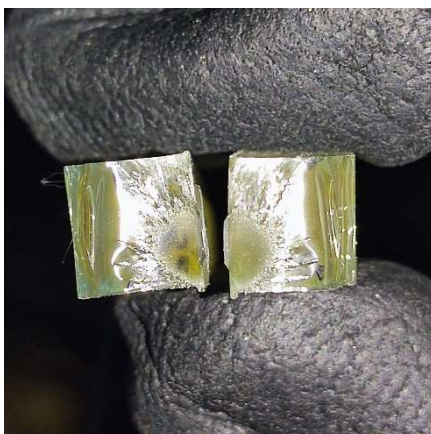
Εικόνα 103 Δοκίμο 3.5 Σημείο θραύσης
