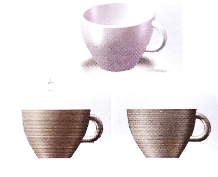
Εικόνα 2 Παρουσιάζεται μια απεικόνιση ενός τεμαχίου (φλιτζάνι) αρχικά σε μορφή CAD και στην συνέχεια εικονίζονται τα αποτελέσματα της κατασκευής AM, με τα αντίστοιχα στρώματα που διακρίνονται. (Ian Gibson, 2017)
