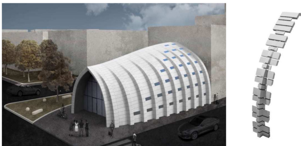
Εικόνα 24: Το προτεινόμενο περίπτερο ANT και η κατασκευαστική λεπτομέρεια μιας πλευράς που αποτελείται από εκτυπωμένα στοιχεία (Masera, Muscogiuri, Bongiovanni, & Colombo, 2017)
