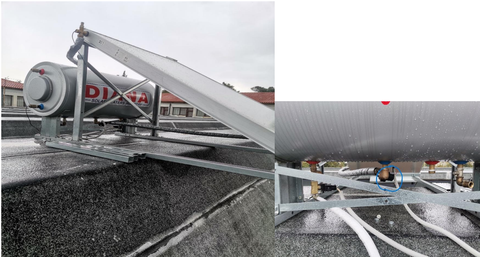
Εικόνα 2. Πειραματική διάταξη εγκατάστασης βεβιασμένης ροής (κλειστού κυκλώματος).
