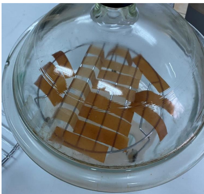
Εικόνα 2. Δείγματα των μεμβρανών κομμένα σε λωρίδες τοποθετημένα σε ξηραντήρα με κορεσμένο διάλυμα MgCl_2 \cdot 6H_2O
