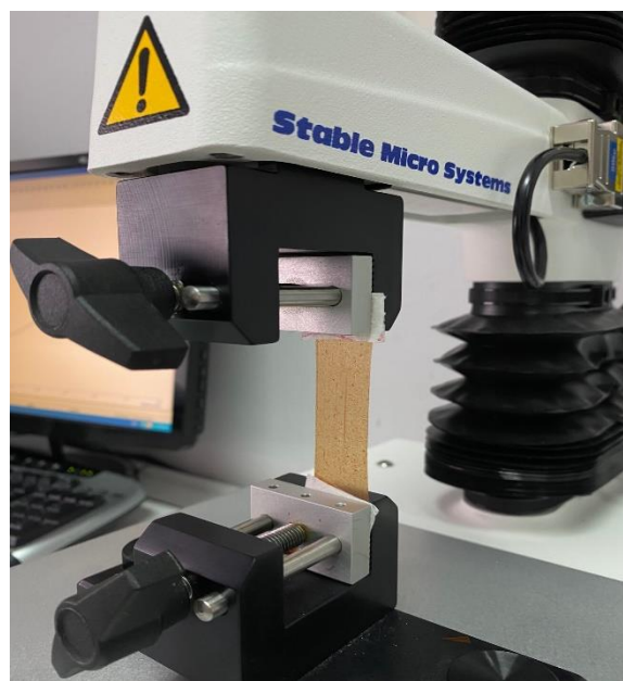
Εικόνα 3. Δείγμα μεμβράνης στον αναλυτή υφής (δοκιμή εφελκυσμού)
