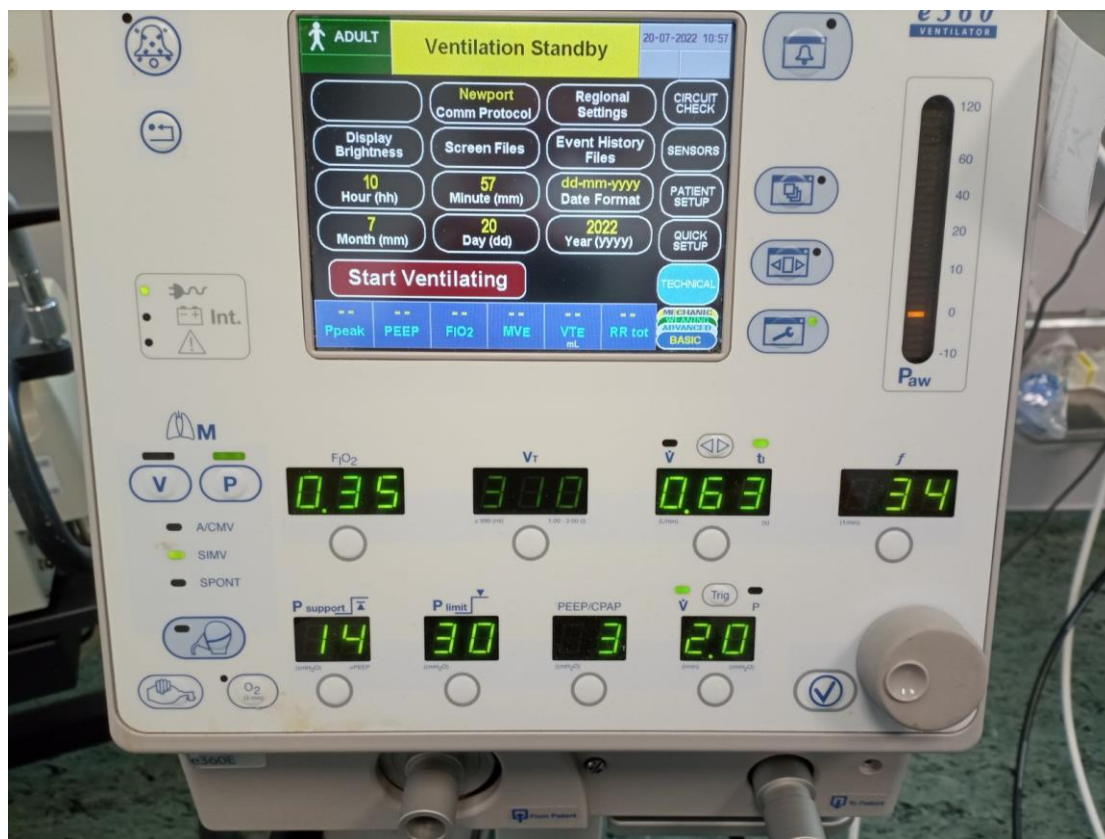
Εικόνα 9 - Πάνελ επιλογών του αναπνευστήρα e360 της Newport (Medtronic)
