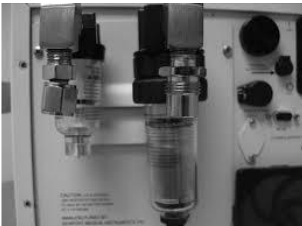
Εικόνα 20 - Υποδοχή αέρα και οξυγόνου σε υποδοχές με φίλτρα και υδατοπαγίδες (Πηγή: https://pdfcoffee.com/newport-ser360-revd-pdf-free.html )
