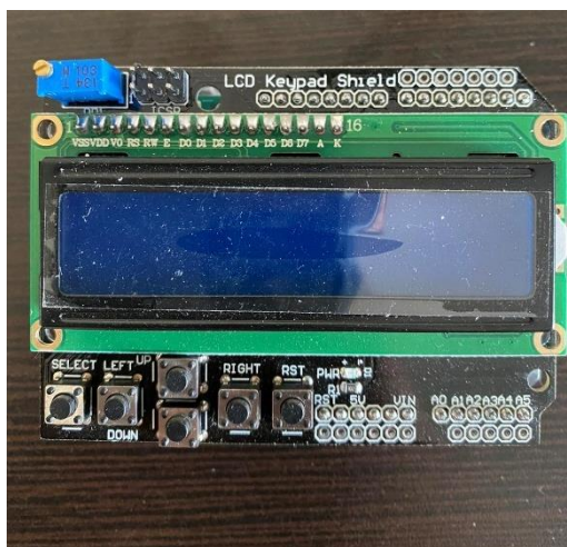
Εικόνα 33 - Arduino UNO μαζί με πλακέτα οθόνης και χειρισμού
