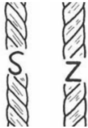
Εικόνα 2.14. Παράδειγμα S και Z στρέψης Εικόνα 2.15. Παράδειγμα απλής πλέξης του υφάσματος
