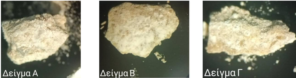
Εικ.5.32, 5.33, 5.34: Εξέταση μορφολογίας της επιφάνειας των δειγμάτων αδιάλυτων αλάτων Α,Β και Γ με το ψηφιακό μικροσκόπιο (DM), Νικοδήμου Π.,2022.
