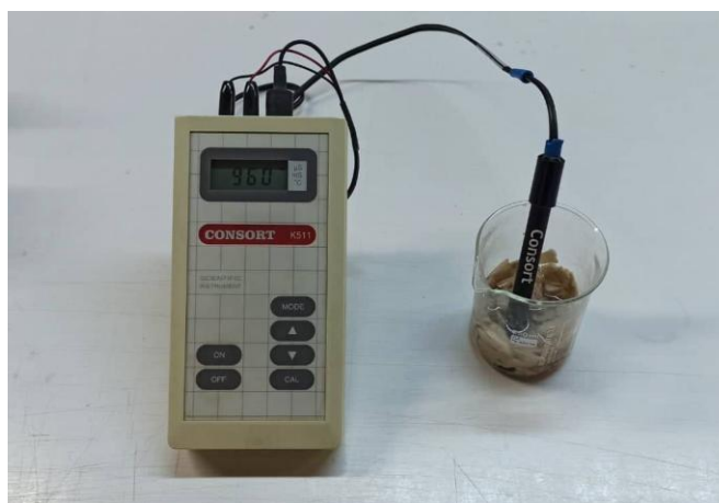
Εικ.5.31: Μέτρηση συγκέντρωσης των διαλυτών/αδιάλυτων αλάτων με αγωγιμόμετρο τύπου Consort K511, Νικοδήμου Π., 2022.
